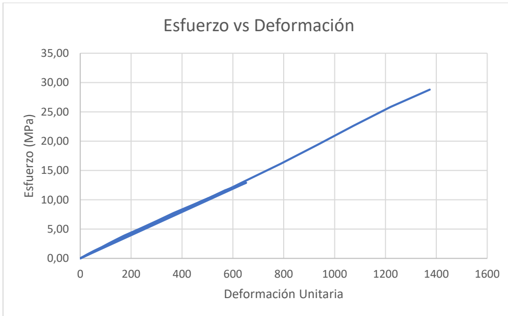
Figura 64. Curva esfuerzo-deformación muestra CEX-PP-1 Fuente: elaboración propia
