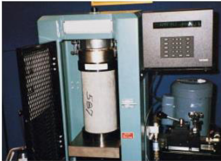
Figura 1. Ensayo de resistencia a la compresión de un cilindro de concreto
