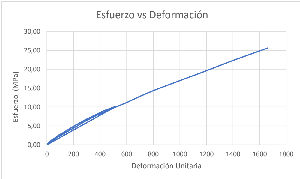
Figura 66. Curva esfuerzo-deformación muestra Muro 2 sept piso Fuente: elaboración propia
