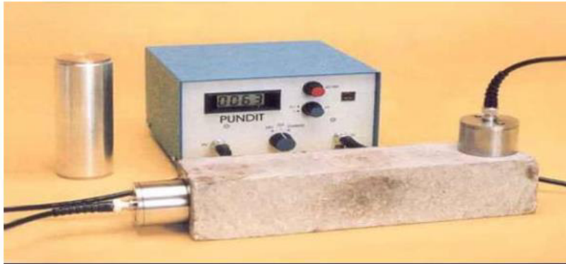
Figura 23. Equipo de ensayo de Velocidad de Pulso Ultrasónico (PUNDIT) Fuente: (Shariati et al., 2011)
