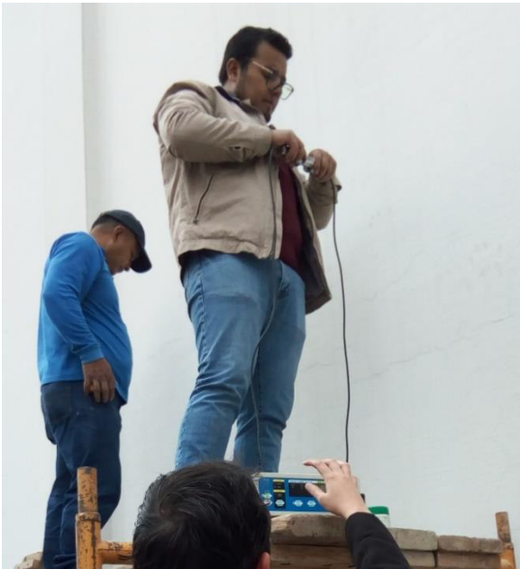
Figura 39. Calibración del equipo utilizado en el ensayo de ultrasonido Fuente: elaboración propia
