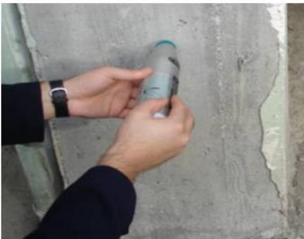
Figura 17. Ensayo del martillo de rebote Schmidt antes de la extracción de núcleos en un edificio existente
