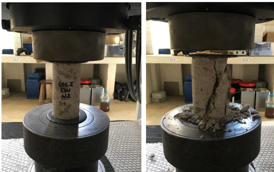
Figura 47. Ensayo de resistencia a la compresión en la máquina universal Fuente: elaboración propia
