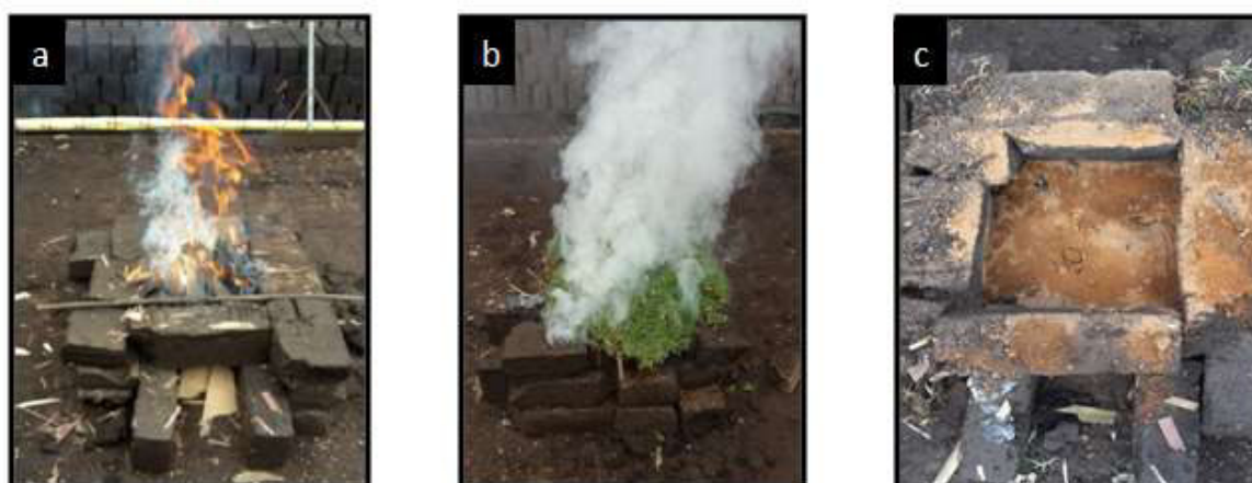
Figura 2.15. a) Quema de la lámina de cartón. b) Cabina de ladrillos cubierta con chamba. c) Apagado del carbón resultante por medio de tierra. (Fuente: Propia, 2021)
