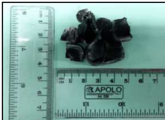
Figura 3.2. Toma de medidas de la muestra de carbón vegetal palo rosa, extraída después del proceso de carbonización dentro del horno sin presencia de aire. (Fuente: Propia, 2021)
