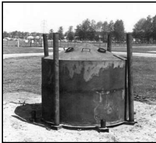
Figura 1.15. Horno metálico. (Fuente: Guillen, 2008)
