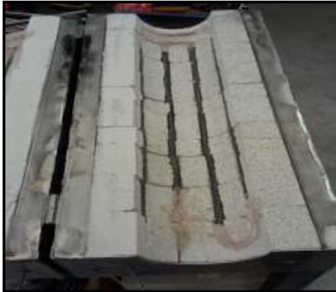
Figura 2.6. Acople de los alambres bobinados dentro de las canaletas. (Fuente: Propia, 2021)
