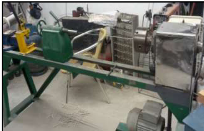
Figura 2.5. Bobinado del alambre Kanthal. (Fuente: Propia, 2021)
