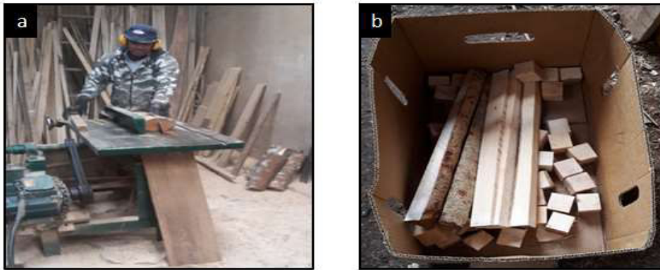
Figura 2.9. a) Corte de los troncos de madera. b) Cubos obtenidos del proceso de corte. (Fuente: Propia, 2021)
