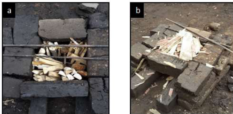
Figura 2.14. a) Cabina de ladrillos no quemados. b) Lámina de cartón cubriendo las especies de madera que se encuentran dentro de la cabina. (Fuente: Propia, 2021)
