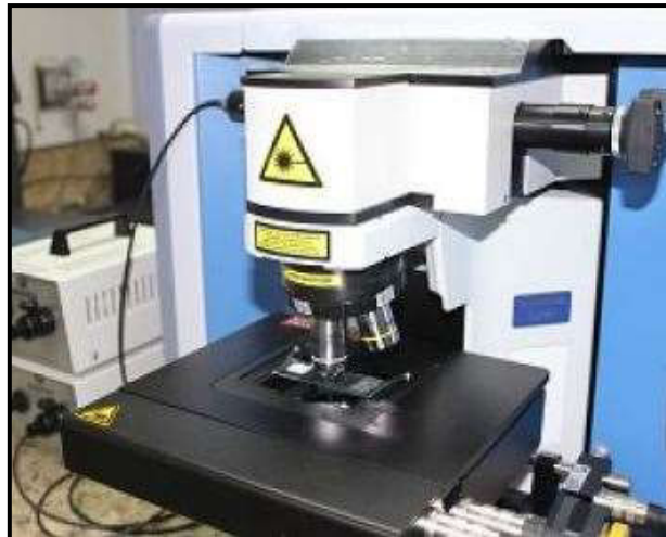
Figura 2.16. Equipo Raman Horiba LabRAM HR Evolution.
