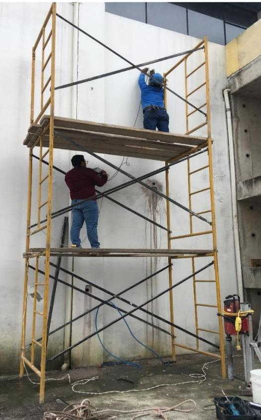
**Figura 41.** Ensayo de ultrasonido – medición indirecta
