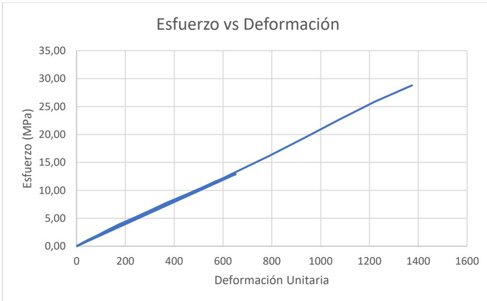
**Figura 64.** Curva esfuerzo-deformación muestra CEX-PP-1
