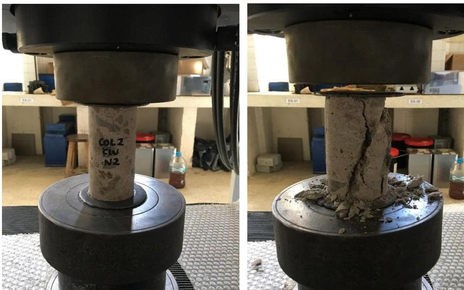
**Figura 47.** Ensayo de resistencia a la compresión en la máquina universal
