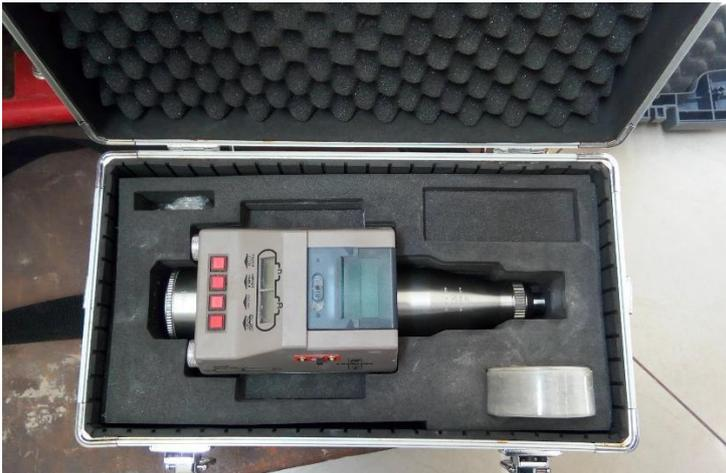
**Figura 36.** Martillo de rebote utilizado en el ensayo
