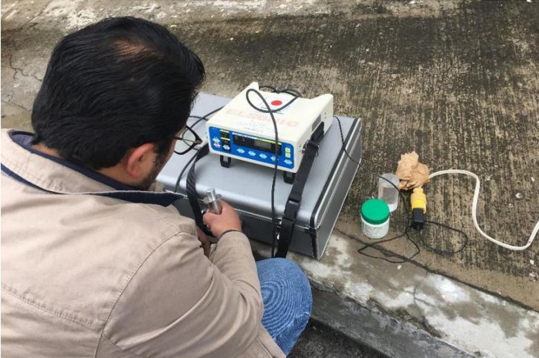
**Figura 38.** Equipo utilizado en el ensayo de ultrasonido
