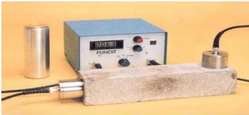
**Figura 23.** Equipo de ensayo de Velocidad de Pulso Ultrasónico (PUNDIT)
