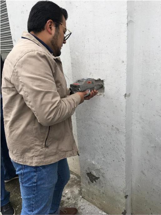
**Figura 37.** Ensayo de rebote en una columna
