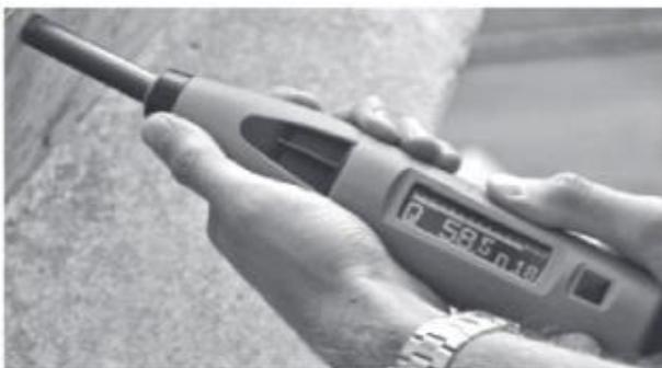
**Figura 11.** Esclerómetro digital
