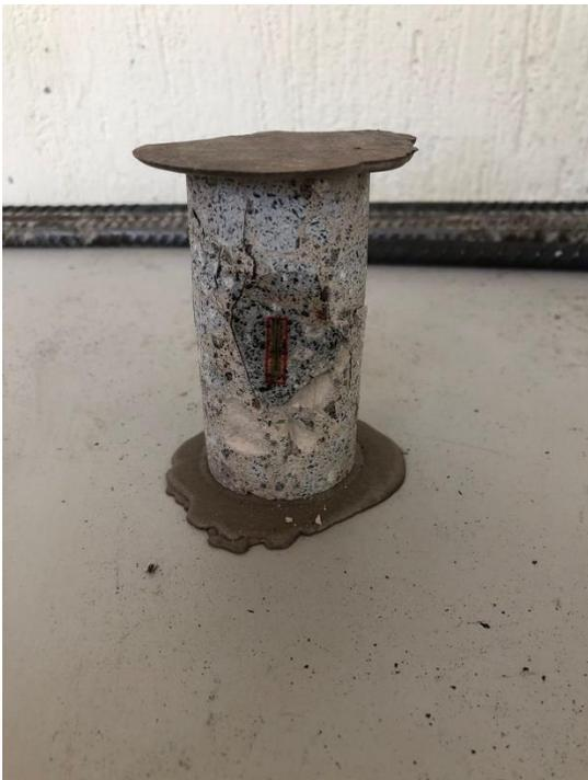
**Figura 48.** Ensayo de módulo de elasticidad
