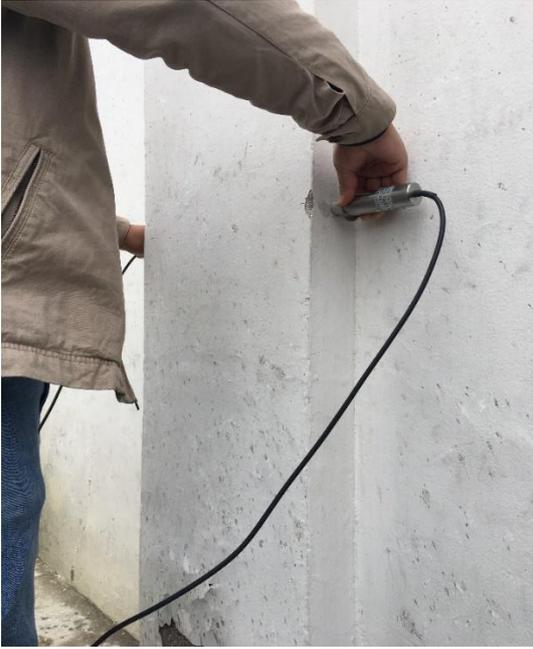
**Figura 40.** Ensayo de ultrasonido – medición directa
