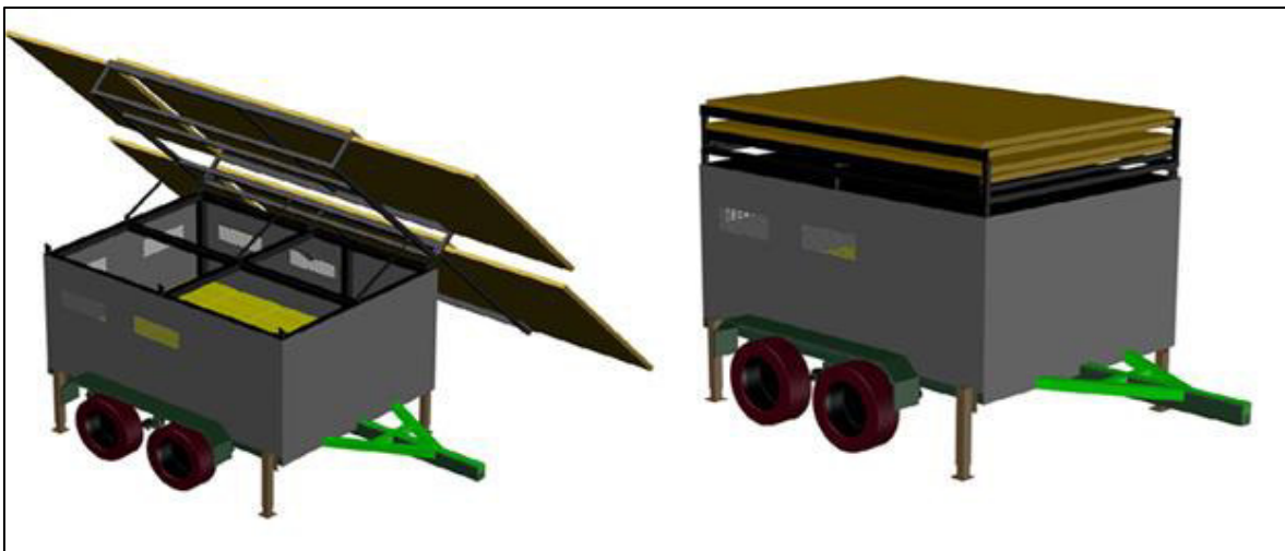
Figura 2.3. Diseño tentativo de remolque para el microsistema solar fotovoltaico [22].
