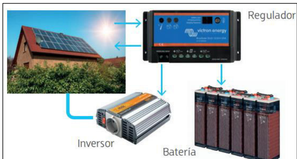
Figura 1.5. Instalación sin conexión a la red eléctrica [5].
