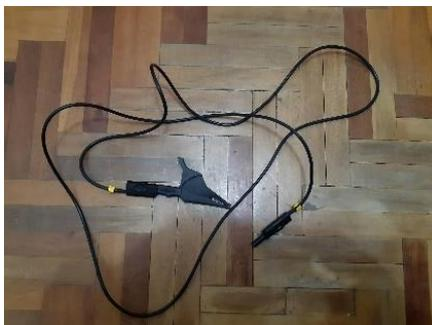
**Figura 2.24.** Pinza de voltaje del CIRCUTOR MYeBOX 1500 [ELABORACION PROPIA].
