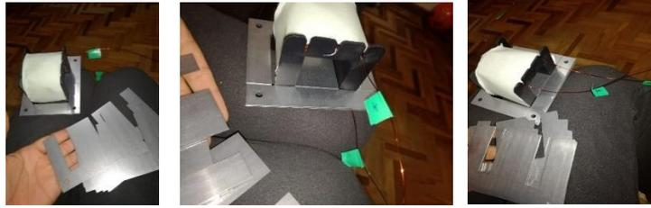
**Figura 3.77.** Colocación de las chapas en forma de E [ELABORACION PROPIA].
