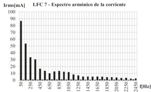
Figura 3.50. Espectro de armónicos de la corriente de una lámpara LFC [18].
