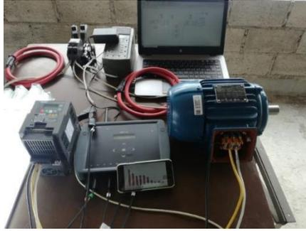
**Figura 3.82.** Conexión total de la carga no lineal [ELABORACION PROPIA].
