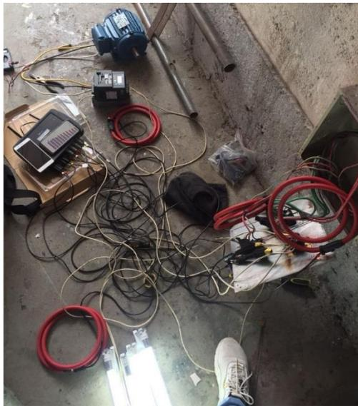
**Figura 3.67.** Puesta en marcha del sistema con la carga no lineal trifásica [ELABORACION PROPIA].
