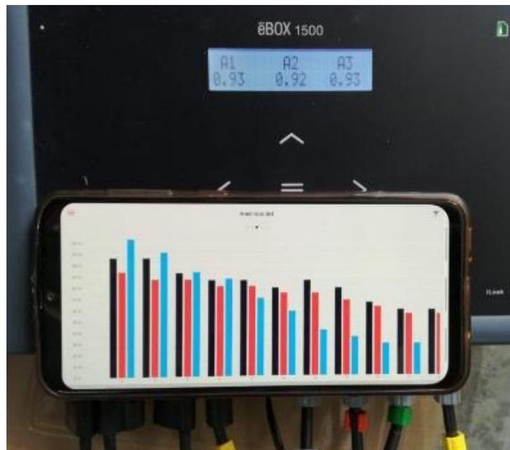
**Figura 4.16.** Espectro de armónicos con datos de corriente por fase [ELABORACION PROPIA].
