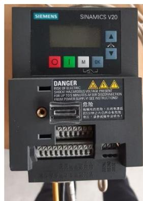
**Figura 3.58.** Variador de velocidad SIEMENS SINAMICS V20 [ELABORACION PROPIA].
