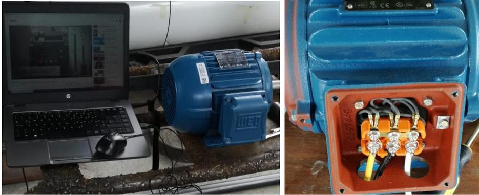
**Figura 3.66.** Conexión interno de los bobinados del motor [ELABORACION PROPIA].
