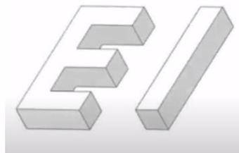
**Fig 3.70.** Chapas en formas de E I del tranformador.
