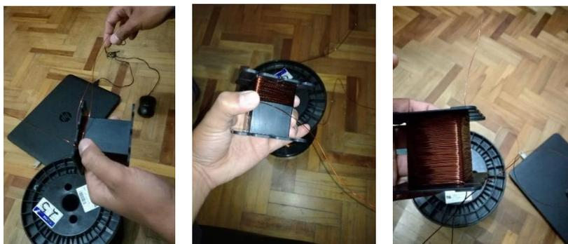
**Figura 3.74.** Bobinado del hilo de cobre en el carrete (Sentido Antihorario)
