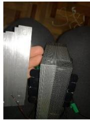
**Figura 3.78.** Colocación de las chapas en forma de I [ELABORACION PROPIA].
