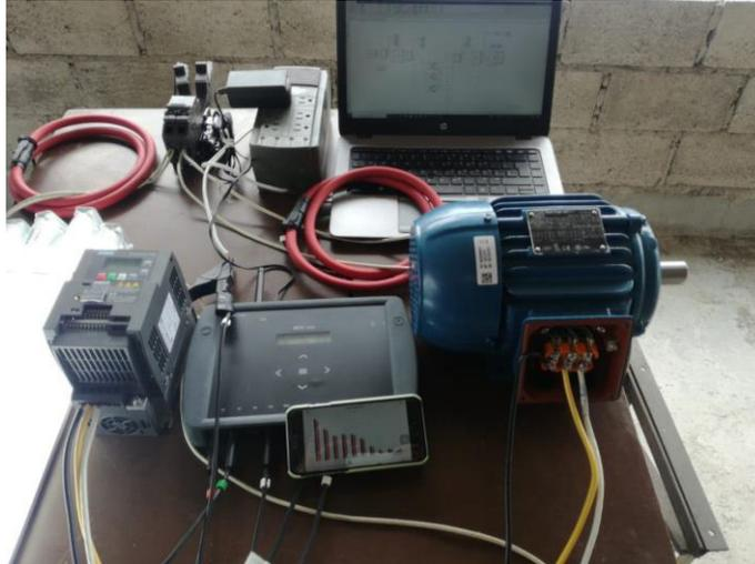
**Figura 3.68.** Armado final de la carga no lineal de la maqueta [ELABORACION PROPIA].
