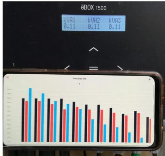
**Figura 4.19.** Espectro de armónicos con datos de potencia aparente por fase [ELABORACION PROPIA].
