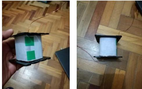
**Figura 3.75.** Colocación de la cinta aislante [ELABORACION PROPIA].
