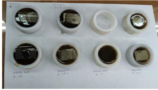
Figura 2.3 Preparación de las probetas ensayos metalográficos y de dureza.
