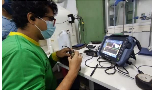
Figura 1.20 Calibración para el ensayo de ultrasonido (longitud de onda ( \lambda )).
