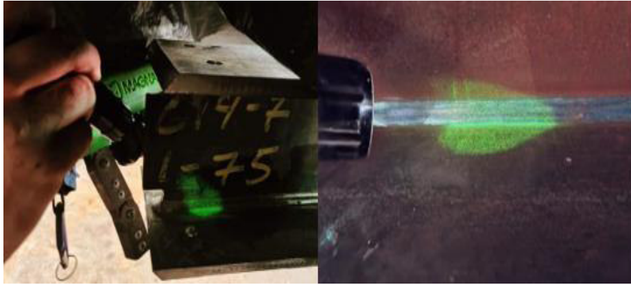
Figura 1.18 Partículas magnéticas en el cordón de soldadura.
