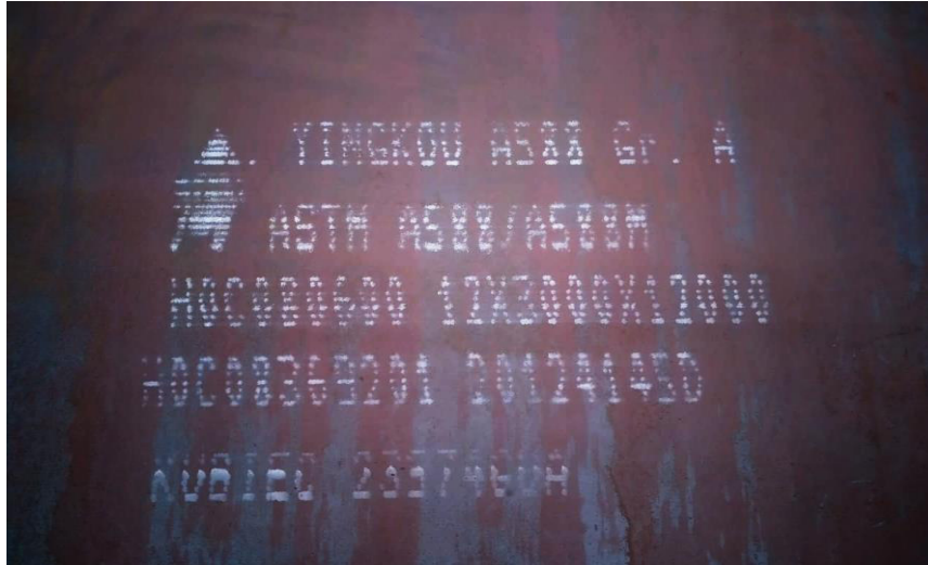
Figura 1.8 Acero estructural ASTM A588 Gr A, tomada en el ámbito laboral de la empresa.
