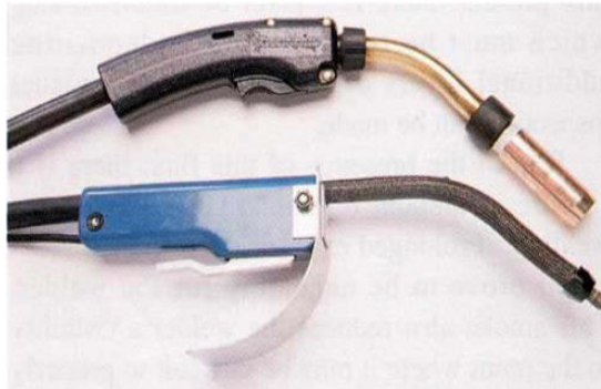
Figura 1.11 Pistola FCAW para electrodos gaseosa (arriba) y autoprotegidos (abajo).
