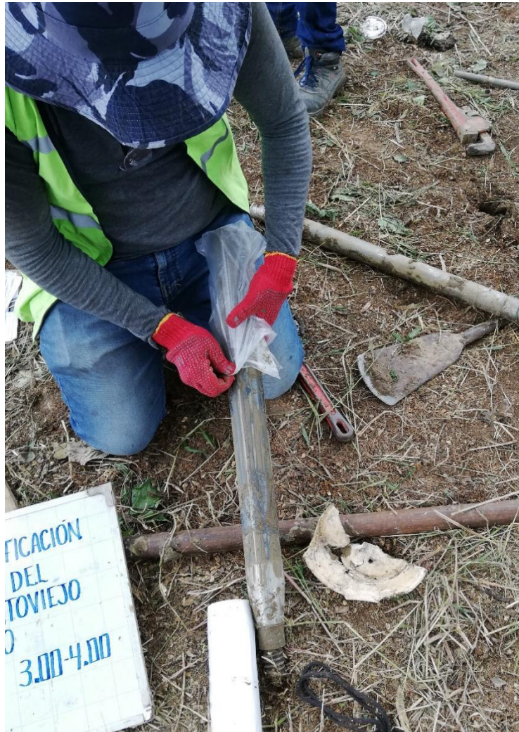
Figura 3.7. Toma de muestra inalterada en tubo Shelby para el sondeo S-02
