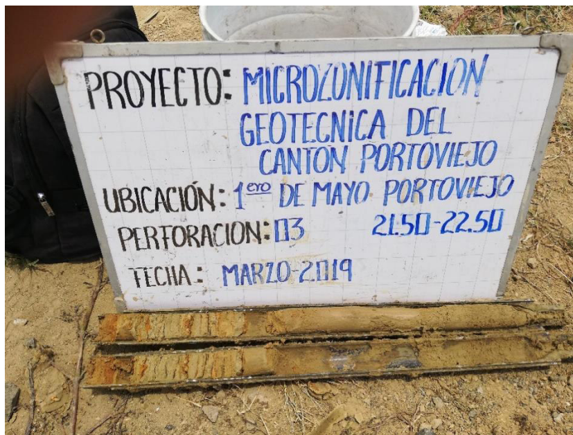
Figura 3.6. Muestras alteradas recuperadas del sondeo S-01 y S-03 durante las perforaciones
