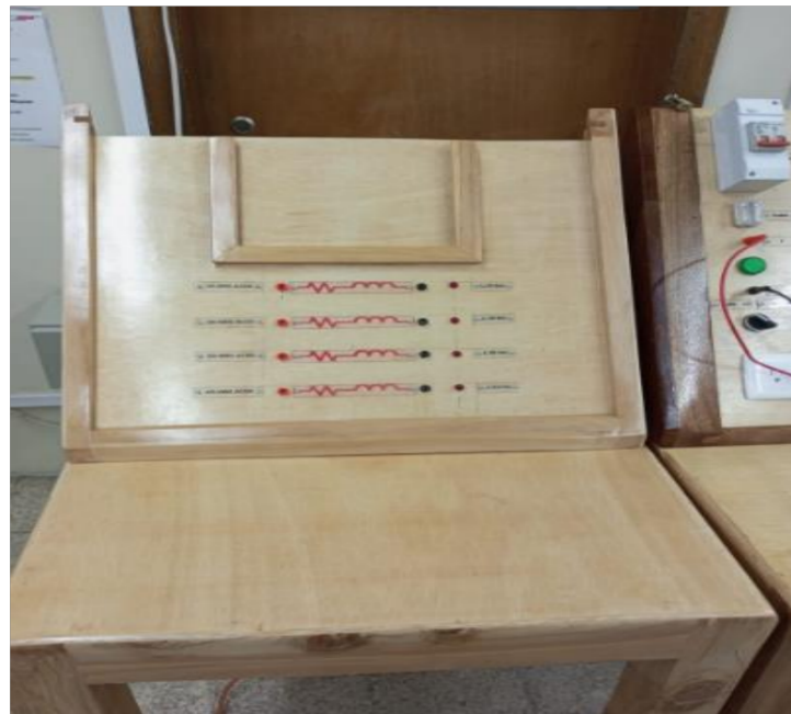
Figura III.6. Construcción del módulo físico en donde se implementa la circuitería correspondiente
