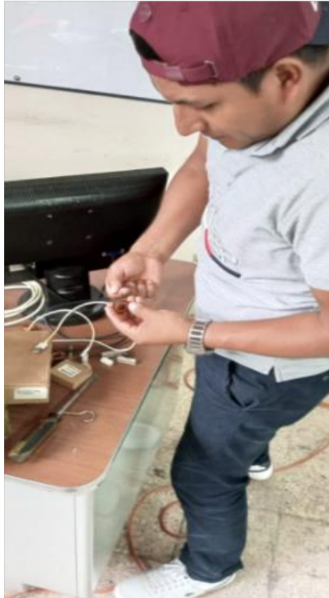
Figura III.5. Construcción de la inductancia para el alimentador primario
