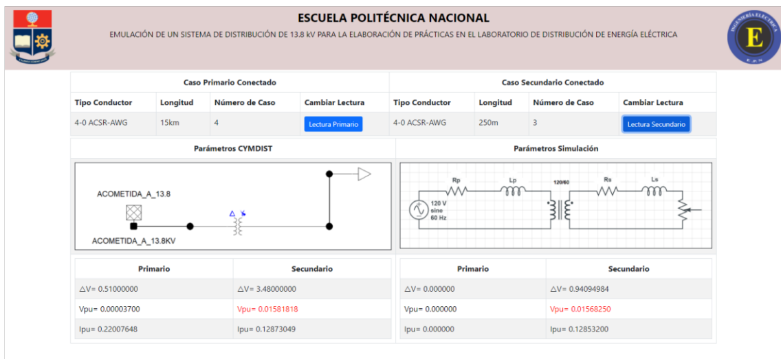
Figura VI.8. Resultados obtenidos mediante la conexión del voltímetro inalámbrico en el circuito secundario, con conductor número 4/0 ACSR AWG de 250m en el circuito secundario
