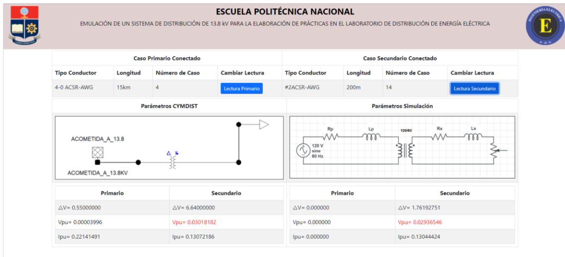
Figura VI.18. Resultados obtenidos mediante la conexión del voltímetro inalámbrico en el circuito secundario, con conductor número 2 ACSR AWG de 200m en el circuito secundario
