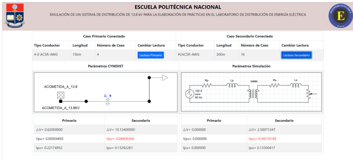
Figura VI.20. Resultados obtenidos mediante la conexión del voltímetro inalámbrico en el circuito secundario, con conductor número 2 ACSR AWG de 300m en el circuito secundario
