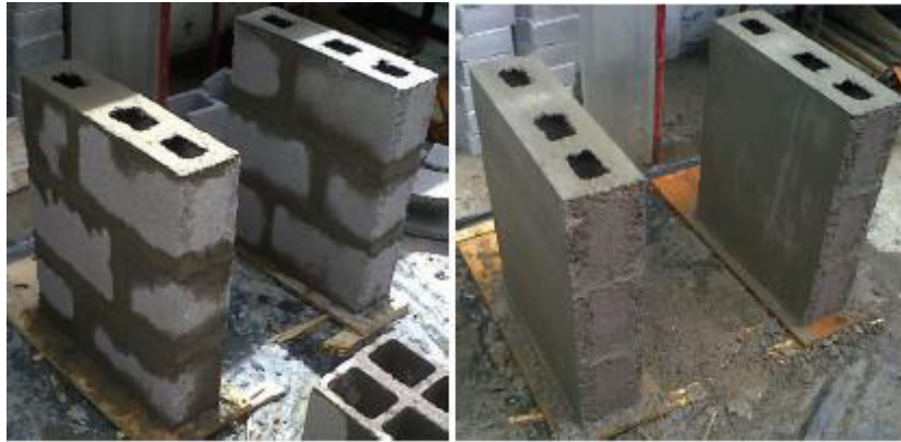
Figura 2.7. Prismas de mampostería enlucidos y no enlucidos
