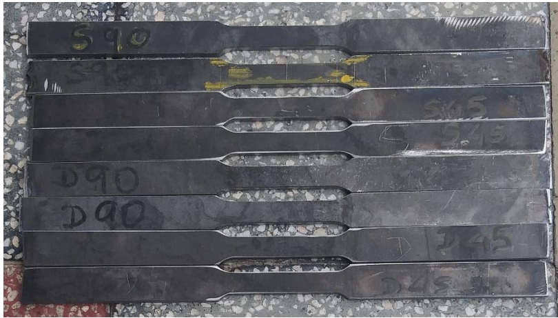
Figura 2.4 Lote de probetas para ensayo de tracción (Fuente propia)
