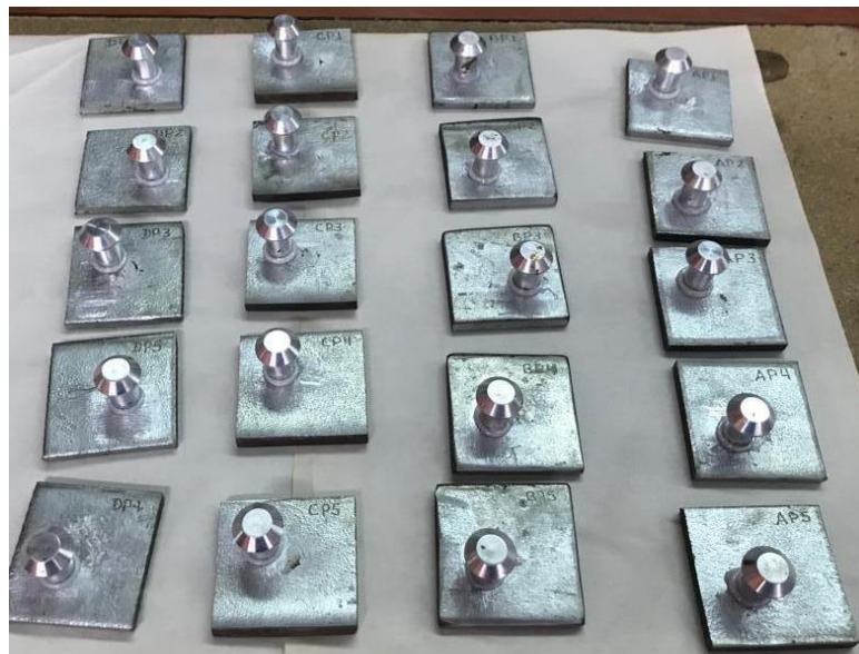
Figura 2.11 Probetas y muñecas listas para el ensayo de pull-off (Fuente propia)
