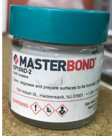
Figura 2.9 Adhesivo epóxico utilizado para ensayo de Pull-off (Fuente propia)
