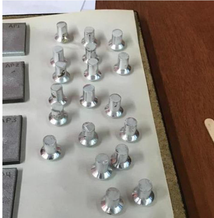
Figura 2.10 Muñecas utilizadas para el ensayo de pull-off (Fuente propia)
