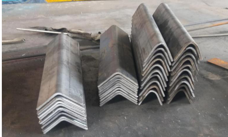
Figura 2.6 Lote de perfiles doblados a 45 a 90 grados (fuente propia)
