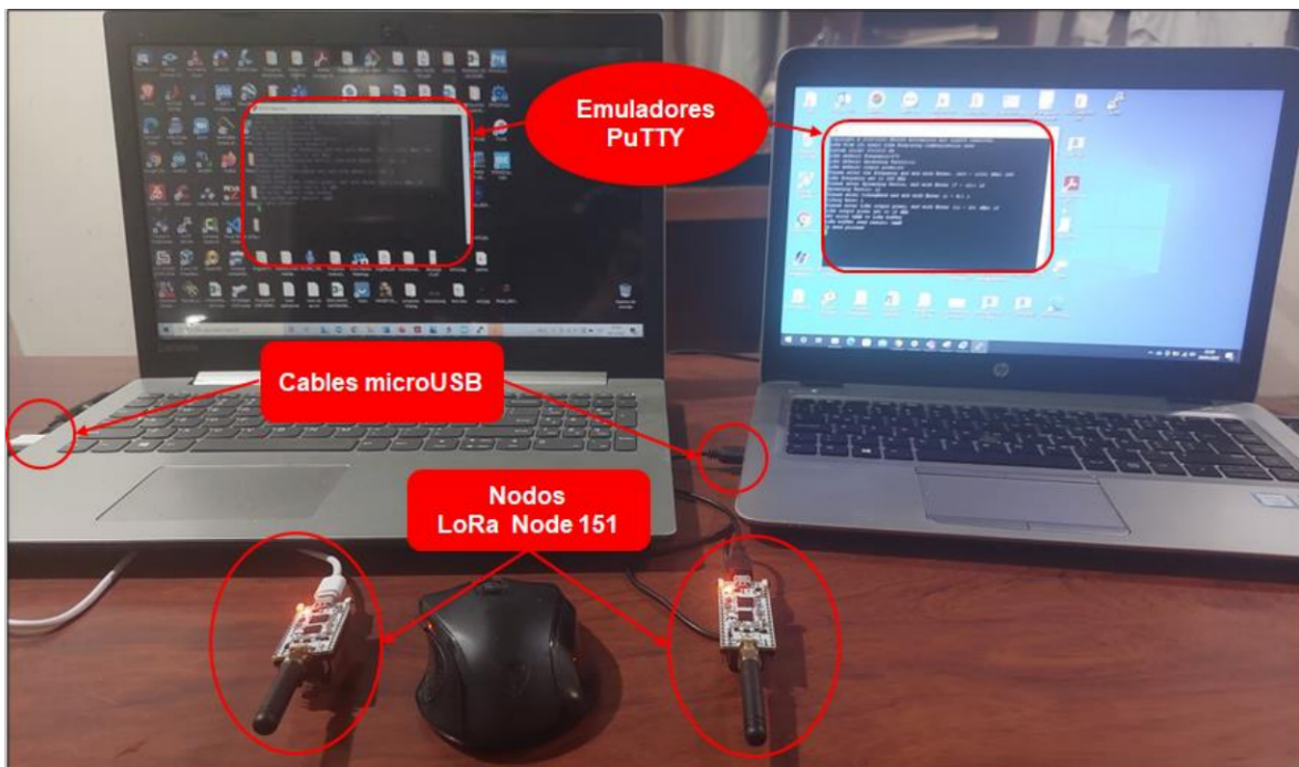
Figura 2.13. Conexión de los dos LoRa Node 151 a dos ordenadores.
