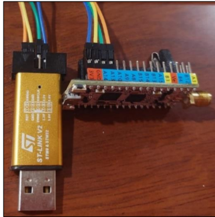
Figura 2.4. Conexión entre ST-LINK y LoRa Node 151.
