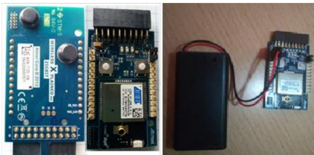
**Figura 1.7** a) Transceptor ATZB-256RFR2 X-PRO. b) Conexión a fuente externa.
