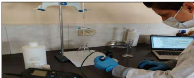
Figura 23. Medición de pH para determinación de alcalinidad.
