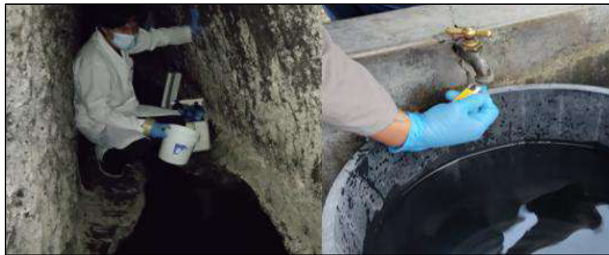
Figura 18. Toma de muestras y esterilización de grifos.
