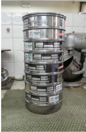
Figura 2.3 Tamices de ensayo, análisis granulométrico
