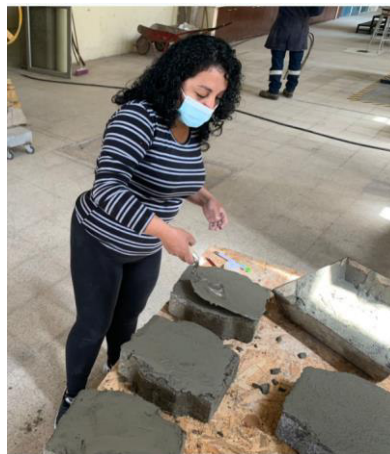
Figura 2.28 Alisamiento de las superficies de los adoquines previo a ensayo de compresión
