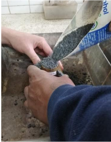
Figura 2.10 Cono con material (arena) salido del horno
