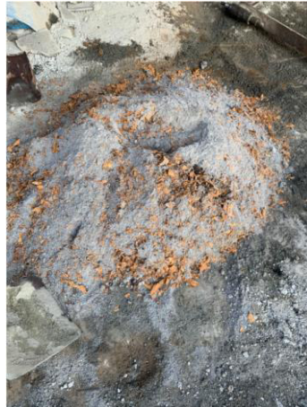
Figura 2.19 Homogenización de residuos peligrosos dosificación 5%
