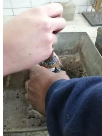
Figura 2.11 Compactación del material (arena)
