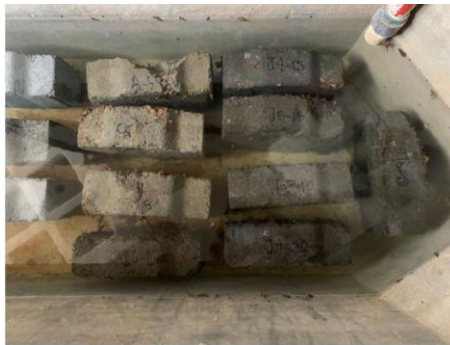
Figura 2.30 Adoquines sumergidos completamente en el agua para ensayos de absorción.
