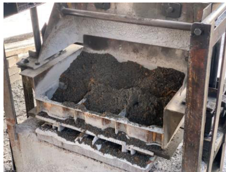
Figura 2.20 Colocación de la mezcla homogenizada en el molde
