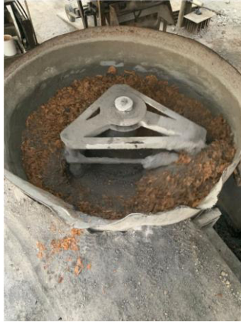
Figura 2.24 Colocación de residuos peligrosos, arena, cemento y agua dosificación 15%
