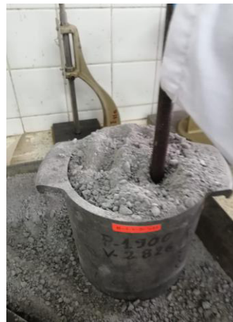
Figura 2.7 Compactación del recipiente en su totalidad de capacidad
