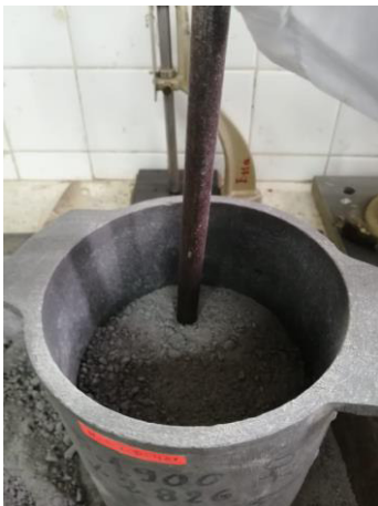
Figura 2.6 Compactación 2/3 partes del recipiente
