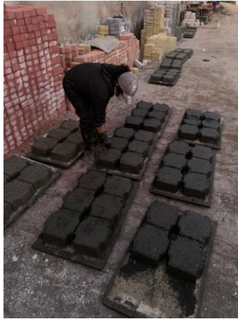
Figura 2.26 Curado de las tres dosificaciones de adoquines
