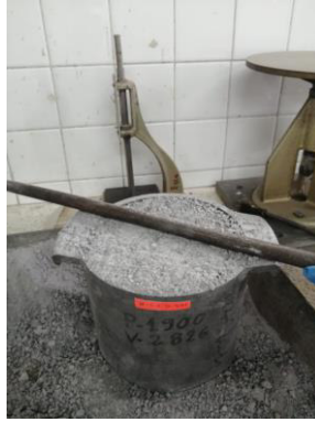
Figura 2.5 Material alineado con la varilla en el recipiente de volumen conocido para cálculo de densidad suelta.
