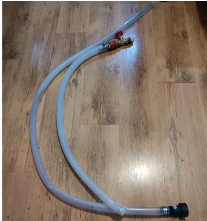
Figura 2.9 – Mangueras para la conexión de bomba y la salida del prototipo.
