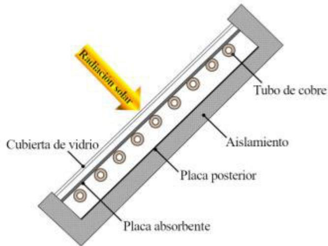
Figura 1.2 – Partes de un colector plano.
