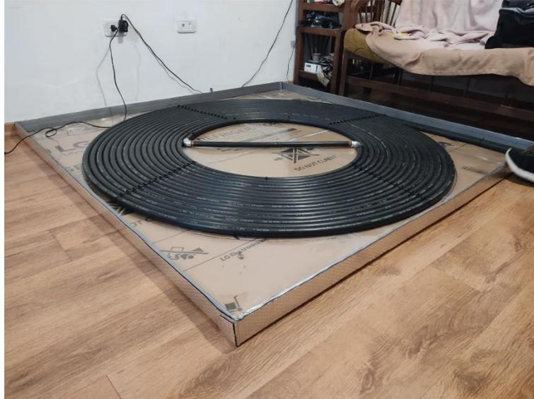
Figura 2.7 – Ensamblaje de la caja y la bobina.
