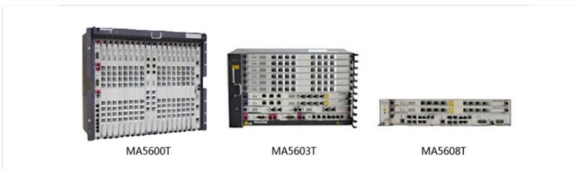
Figura 2.6. Modelos de OLT marca Huawei [22].
