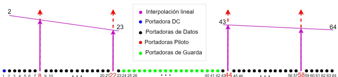
**Figura 2.152.** Estructura de un símbolo OFDM e interpolación lineal.
