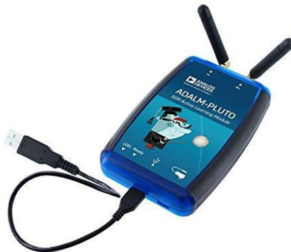
**Figura 1.1.** Dispositivo SDR Adalm Pluto, con el cable USB 2.0 y dos antenas conectadas.
