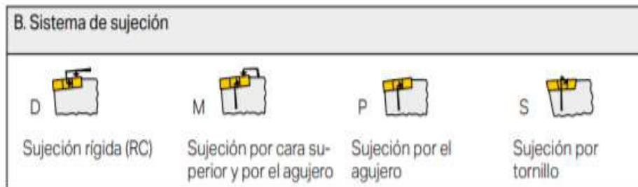
Figura 14. Sistemas de sujeción entre portaherramientas e insertos.
