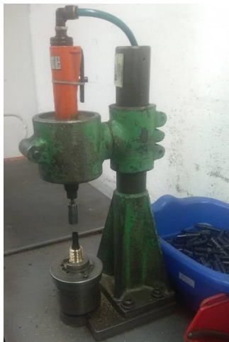
Figura 1.9. Máquina de prensado de válvulas de gas.
