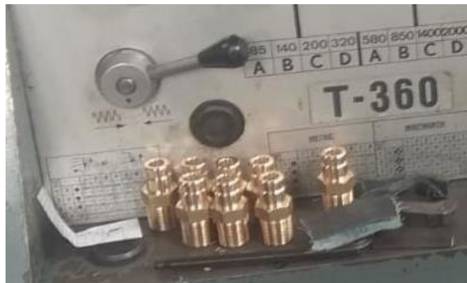
Figura 2.25. Válvulas de gas de bronce listas para ser medidas.
