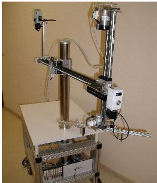
Figura 2.19. Sistema de movimiento mediante electromecánica. (Fuente: Dobontech, 2012)
