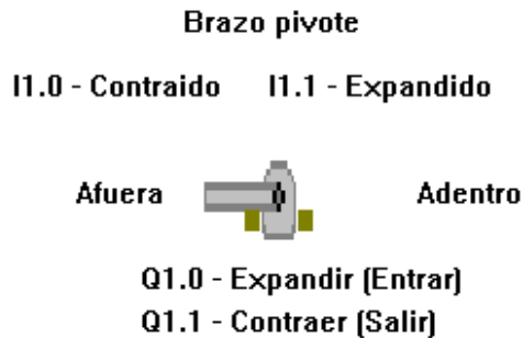
Figura 2.52. Representación del brazo pivote del primer peldaño en el simulador PCSimu.
