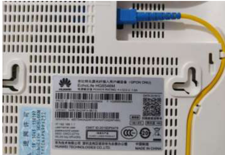
Figura 3.25 Pigtail conectado a la ONT
