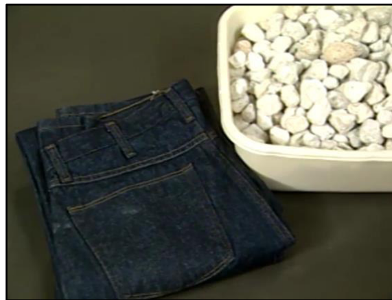
Figura 3.3. Material utilizado para proceso de abrasión de tela. [2]
