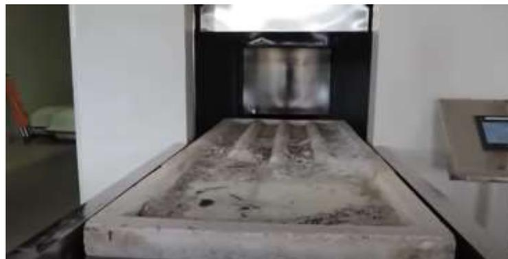
**Figura 1.5.** Compuerta de entrada incinerador.
