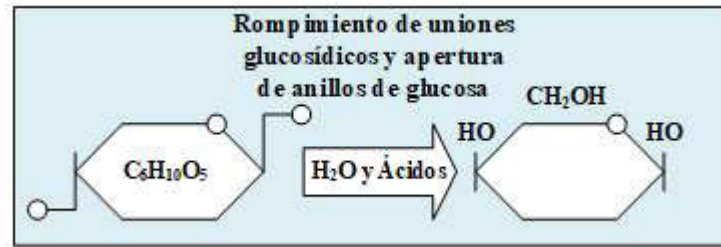
Figura 10. Fractura de enlaces de glucosa por efectos de hidrólisis y acidez en el aceite [9]
