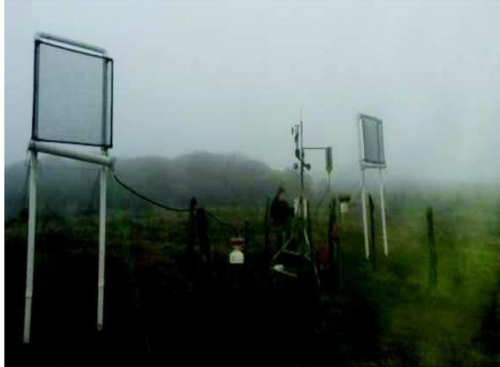
**Figura 8.** Captadores de Niebla instalados en la Isla San Cristóbal
