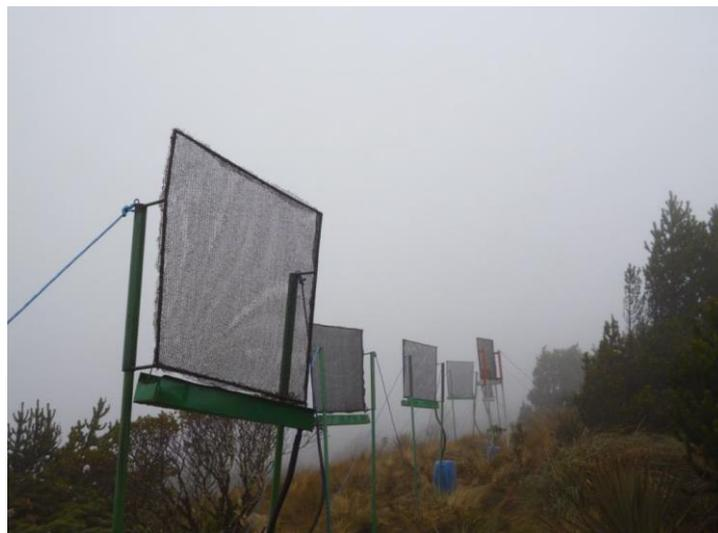
**Figura 6.** Captadores de Niebla instalados en Quero-Tungurahua
