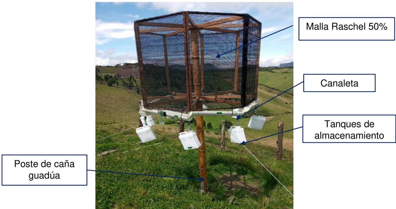
**Figura 28.** Captador de niebla Diseño Tridimensional
