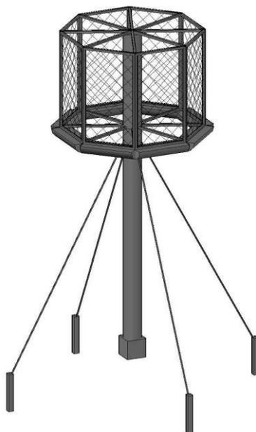
**Figura 15.** Diseño captador de niebla bidimensional
