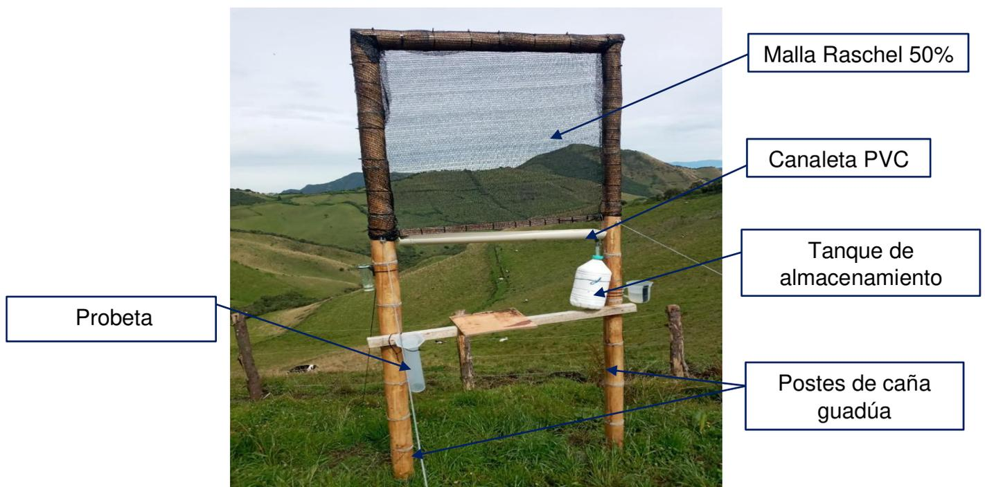
**Figura 27.** Captador de niebla Diseño Bidimensional
