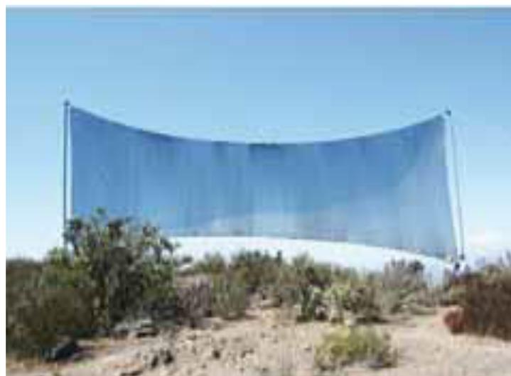
**Figura 2.** Captador de Niebla Bidimensional
