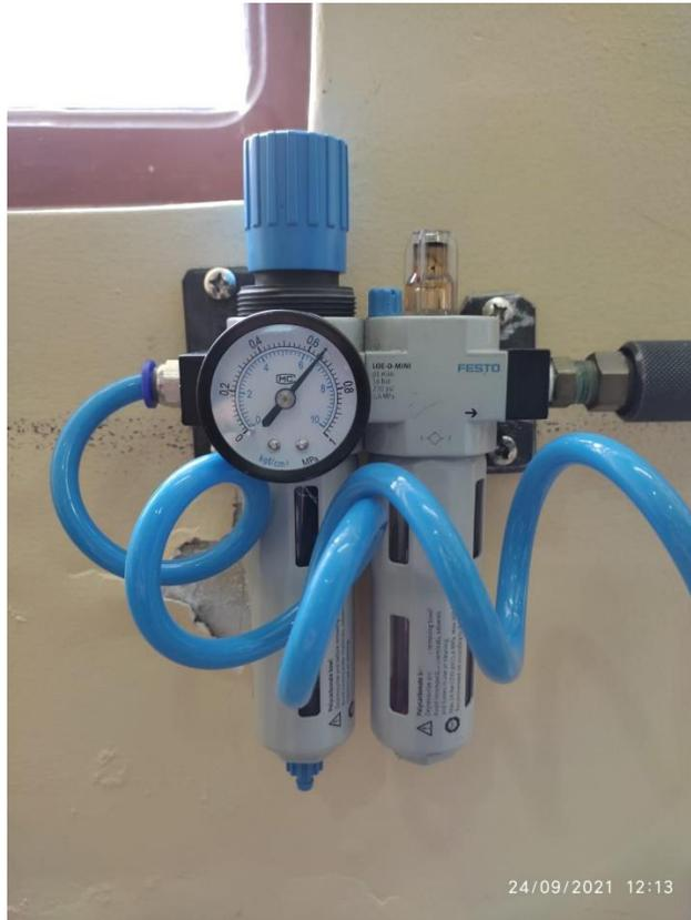
**Figura 3.16** FRL con su toma rápida y manguera conectada
