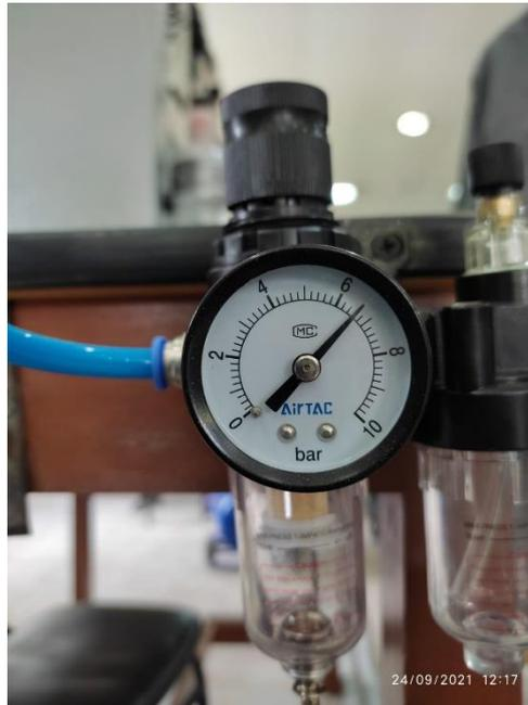
**Figura 3.20** Lectura del manómetro del FRL (6.6 Bares)
