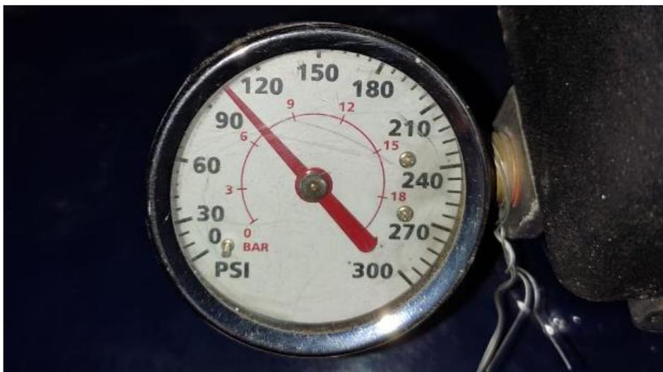
**Figura 3.19** Lectura del manómetro del compresor (7 Bares).
