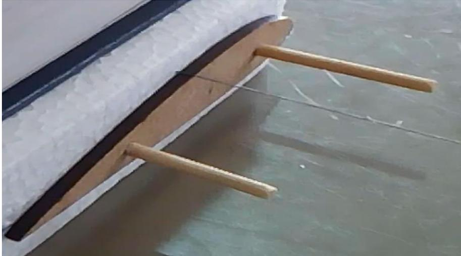
Figura 1.10. Corte de un perfil alar con hilo de nicromo.
