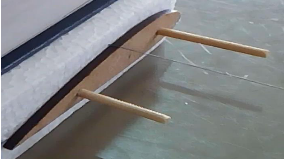
Figura 1.10. Corte de un perfil alar con hilo de nicromo. (Fuente: Propia)
