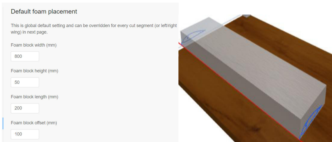
Figura 3.32. Establecer dimensiones del bloque de espuma. (Fuente: Propia)
