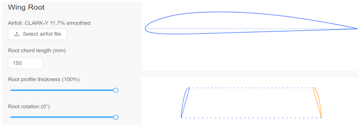
Figura 3.26. Configuración de perfiles aerodinámicos. (Fuente: Propia)
