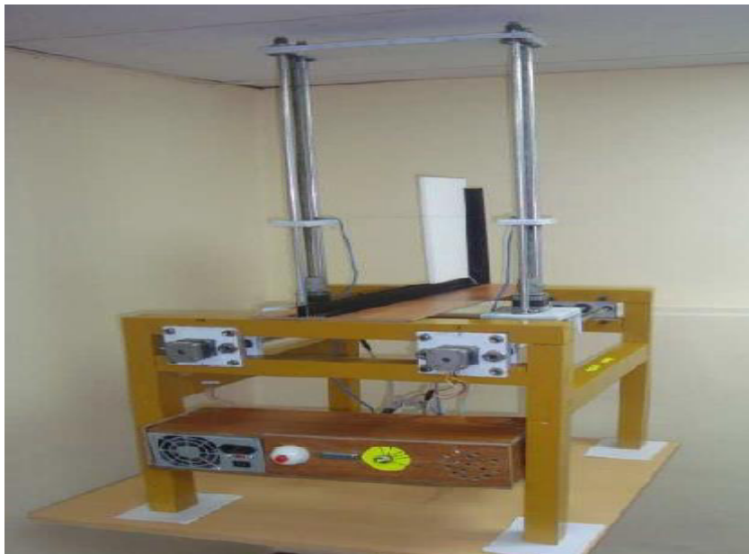
Figura 1.8. Prototipo de cortadora de espuma de poliestireno con control numérico computarizado.
