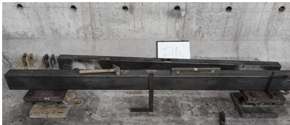
Figura 3.4 Ubicación de la columna para ser soldada a las placas Foto: Nicole Guerrero
