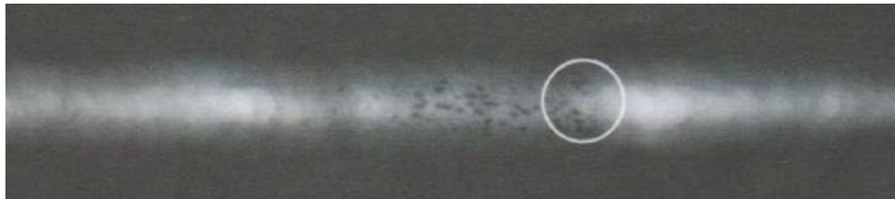
Figura 2.22 Radiografía de porosidad en la soldadura Fuente: (AWS, 2008)
