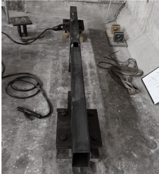
Figura 3.5 Ubicación de la columna para ser soldada a las placas (columna para la conexión experimental) Foto: Nicole Guerrero
