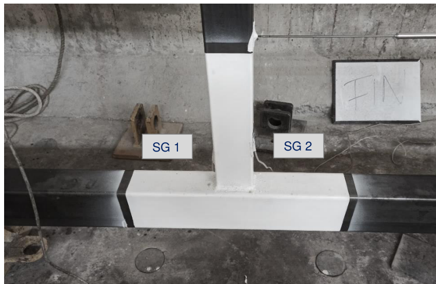
Figura 3.10 Ubicación de los Strain Gauges Foto: Nicole Guerrero
