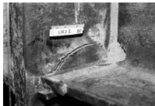
Figura 2.23 Fallas en la conexión viga – columna en sismo de Northridge Fuente: (FEMA 355F)
