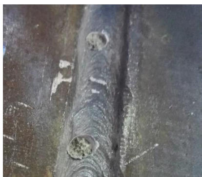
Figura 2.19 Inclusión de escoria Fuente: (Castro y Serrano, 2016)
