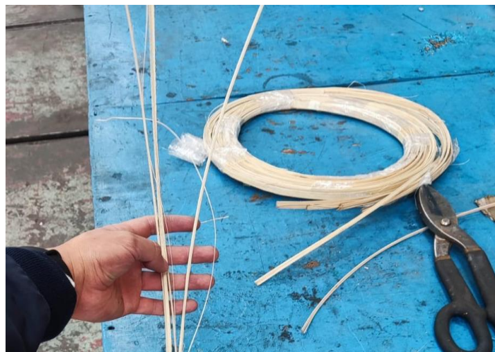
Figura 2.8. Láminas de bambú par ingreso a máquina.
