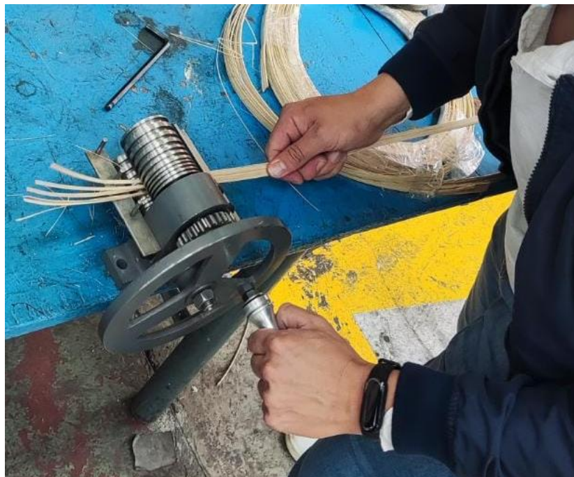
Figura 3.2. Desfibrado con prototipo.
