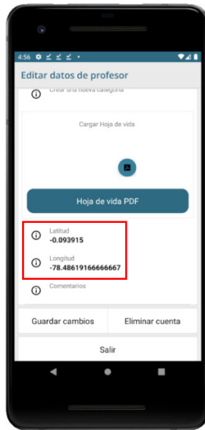
Figura 3.31. Actualización de manera automática de la posición mediante los campos “Longitud” y “Latitud”
