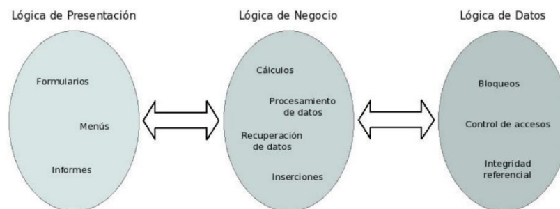
Figura 1.4. Arquitectura Multinivel de Tres Capas [9]
