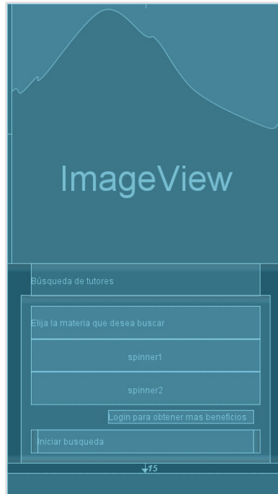
Figura 2.8. Diagrama de la Activity para realizar búsquedas
