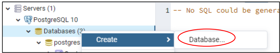
Figura 2.18. Creación de base una base de datos en el motor PostgreSQL
