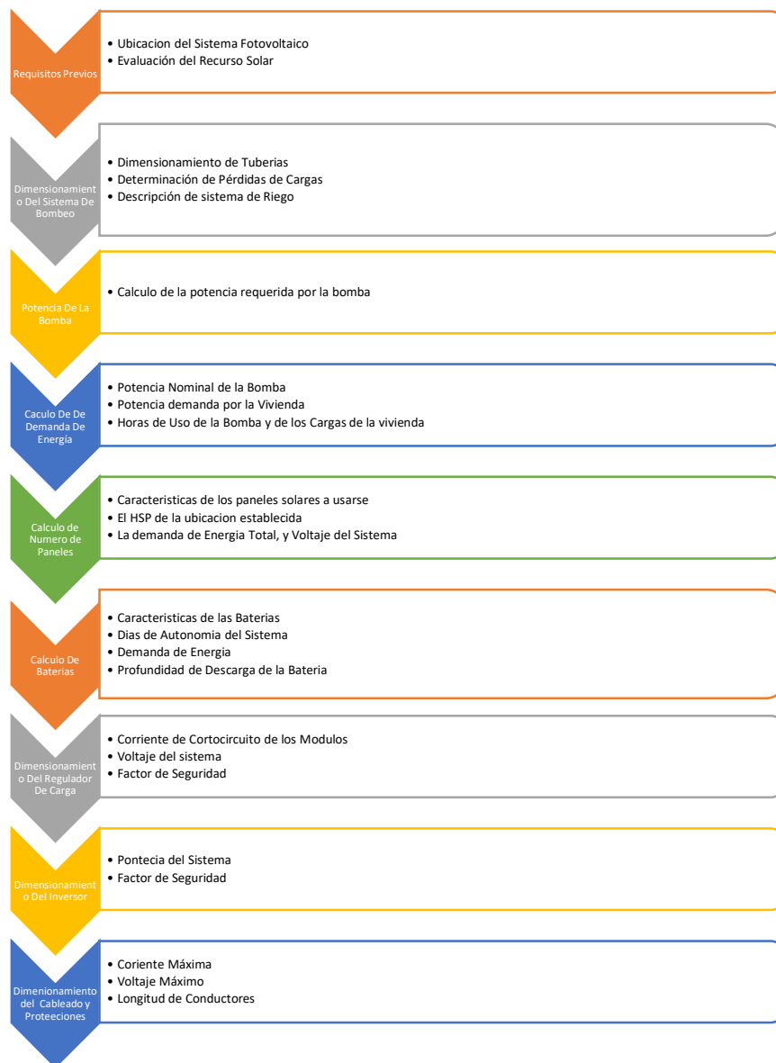
Figura 2.1. Diagrama de Metodología para dimensionar un sistema fotovoltaico de un sistema de riego con pequeña vivienda
