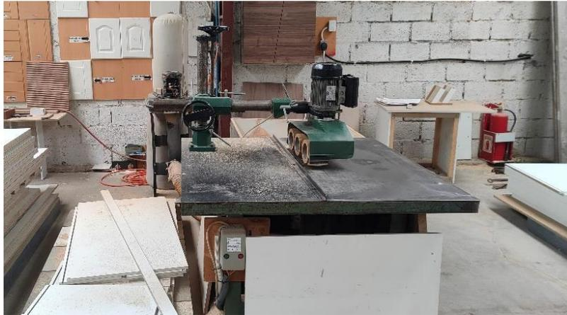
**Figura 2.9.** Proceso de acanalado
