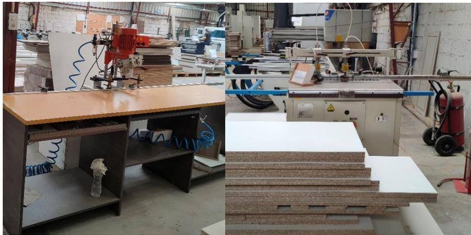
**Figura 2.8.** Proceso de perforado
