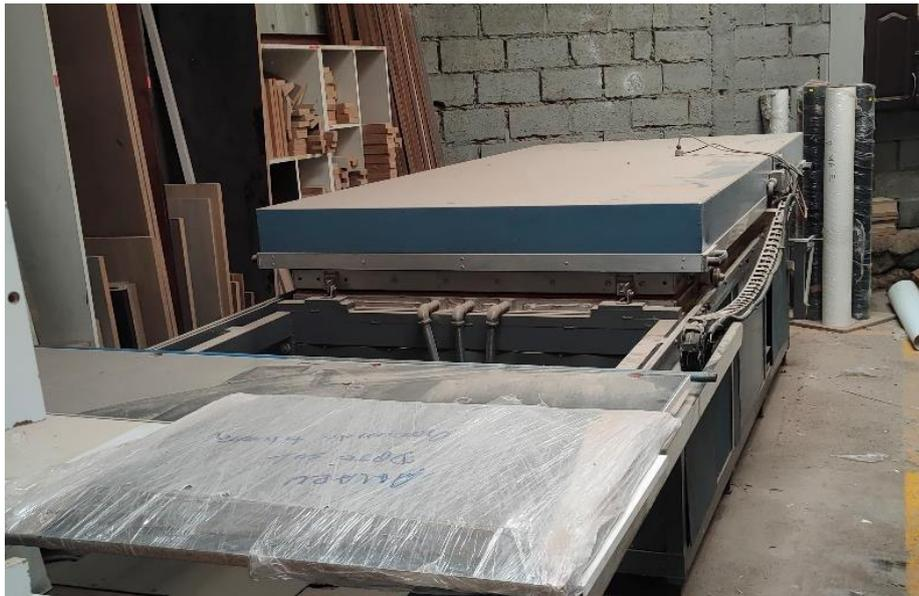
**Figura 2.6.** Proceso de termolaminado
