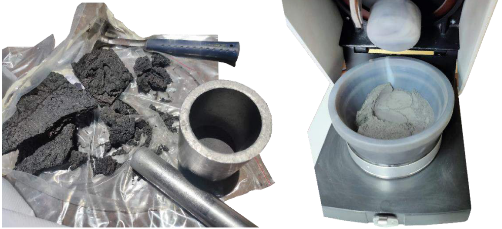
Fig. 2.22. Trituración de muestras de roca. Izquierda: mortero de titanio. Derecha: Molino de ágata Retsch RM 200.
