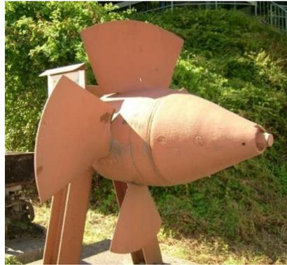
Figura 1.1. Primer modelo físico de la Turbina Kaplan.
