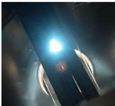
Figura 4-38. Spot visible sobre el polvo fosforescente depositado en la pantalla de la figura 4-37, esta fue colocada a 526,5 [mm] de la pistola de electrones
