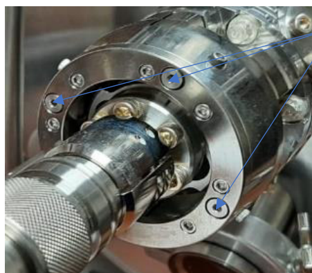
Figura 4-8. Zona trasera de la pistola de electrones. Tornillos utilizados para realizar el ajuste del haz de electrones.
