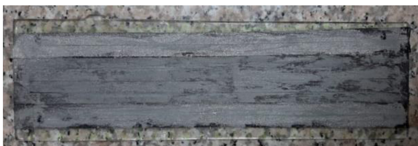
Figura 4-37. Polvo fosforescente depositado sobre cinta doble faz conductora sobre un vidrio de 3 [mm]
