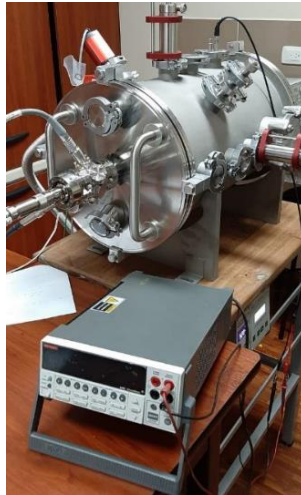
Figura 4-13. Conexión externa de pasos giratorios, paso eléctrico, cable coaxial y multímetro Keithley 2400 S.
