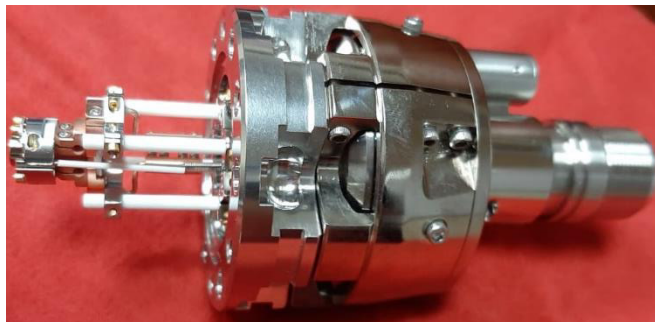
Figura 4.9 Zona que contiene la grilla con el cátodo
