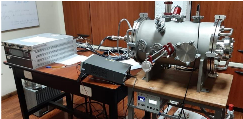
Figura 4-1. Equipo completo, consolas de operaciones, pistola de electrones, cámara de vacío, bombas, pasos mecánico y multímetro
