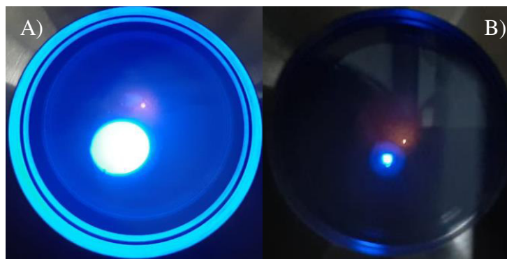
Figura 4-41. Spot alineado y enfocado con V_A 7 [keV] A) Sin enfocar, B) V_F 3,44 [kV]
