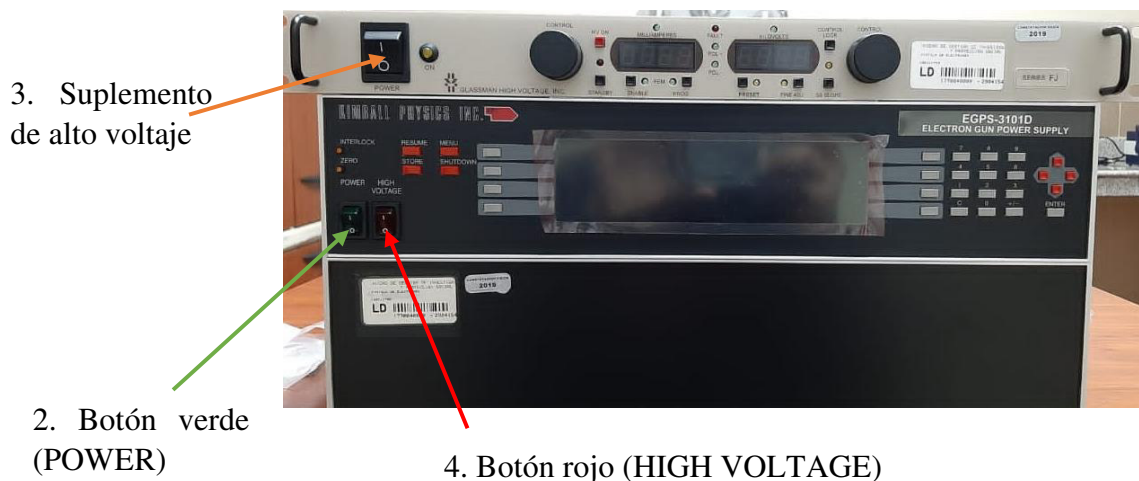
Figura 2.6 Proceso de encendido de la pistola de electrones
