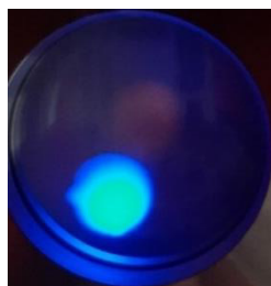
Figura 4-7. Spot de V_A 2,5 [keV] con V_C 1,4 [V] no alineado visible en la pantalla fosforescente
