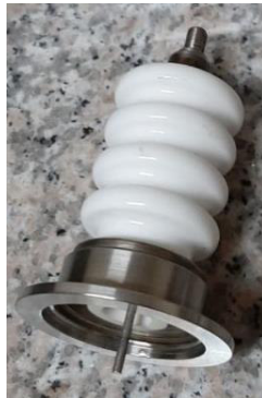
Figura 3-8. Paso eléctrico para alto voltaje con pin para vacío
