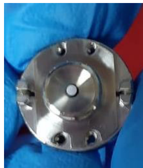
Figura 4.16 Integración de la zona frontal de la grilla y alineamiento del nuevo cátodo
