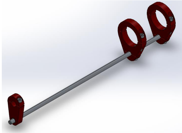
Figura 3-3. Elemento externo del paso giratorio bloqueador de giro anti-twist [18]
