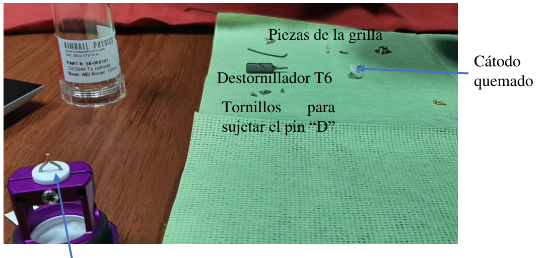
Figura 4.14 Elementos utilizados en el cambio del cátodo, con el cátodo nuevo en su transportador y el cátodo quemado
