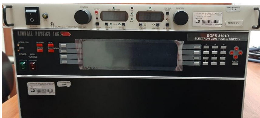
Figura 1.1 Consolas que controlan la pistola de electrones e la parte superior se encuentra la serie FJ y en la parte inferior la consola EGPS-3101D
