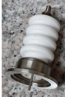
Figura 1.12 Paso eléctrico de alto voltaje
