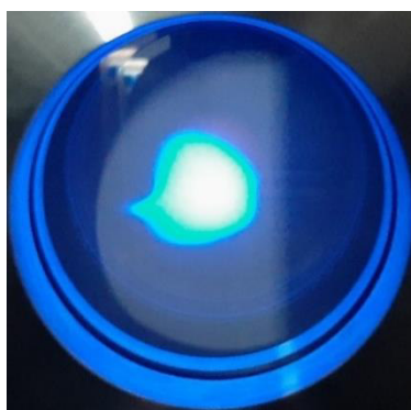
Figura 4-9. Spot de V_A 2,5 [keV] con V_C 1,4 [V] centrado y alineado, presenta una forma extraña al estar aplicada la deflexión.
