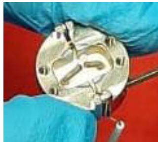
Figura 4.15 Nuevo cátodo dentro del cuerpo de la grilla
