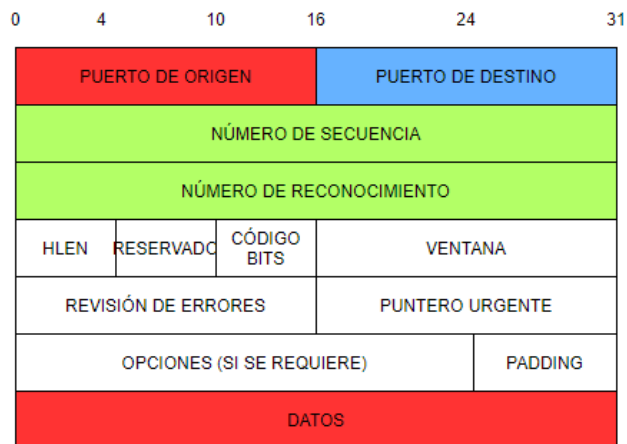
Figura 1.6. El formato de un segmento TCP con un encabezado TCP seguido de información [10].
