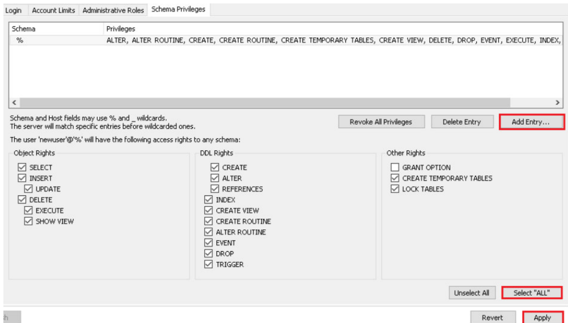
Figura B.5 Pantalla de configuración de nuevo usuario en MySQL Workbench.
