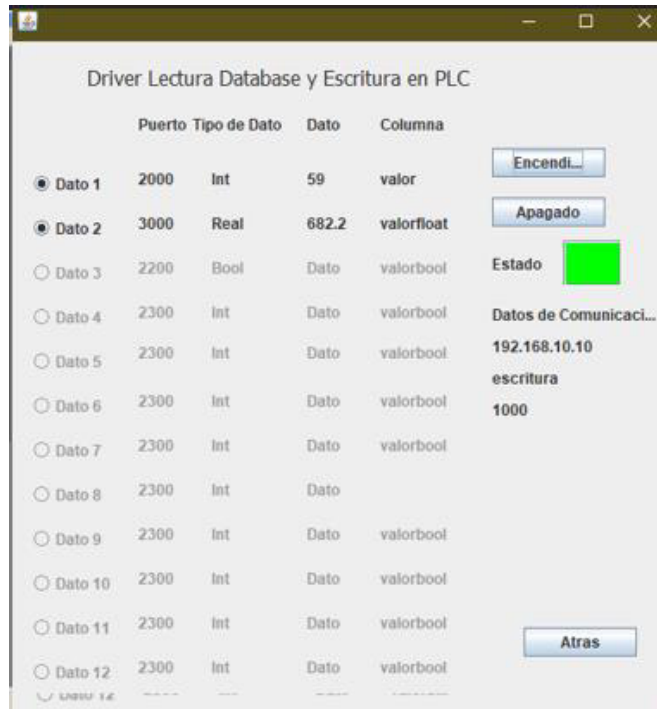
Figura 2.26. Ventana de Operador de conexión de escritura del PLC.
