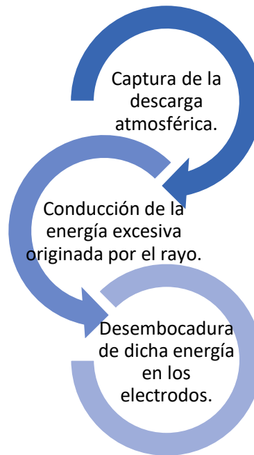
Figura 2.14. Esquema de funcionamiento de un pararrayo.
