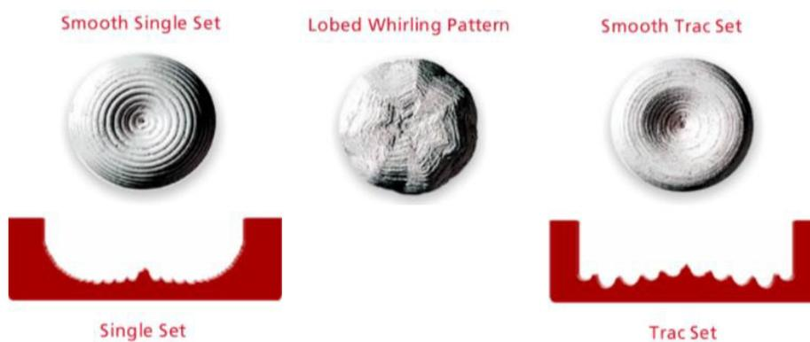
Figura 35 Representación de los perfiles generados en el fondo del pozo
