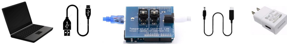
Figura 1.2. Conexión y energización del laboratorio de control de temperatura [5]
