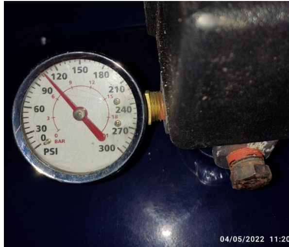
Figura 3.32 Lectura después de 30 minutos de presurizar el sistema
