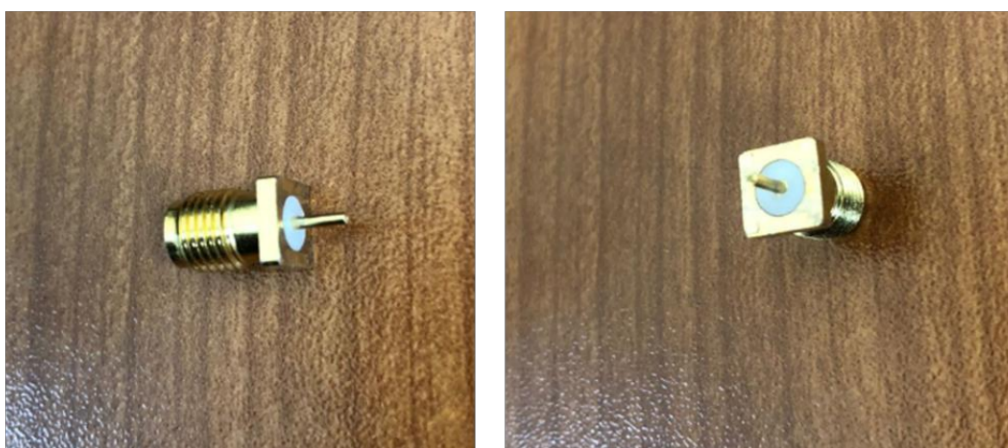
Figura 3.7 Conectores SMA modificados para interconexión con la estructura de la antena.
