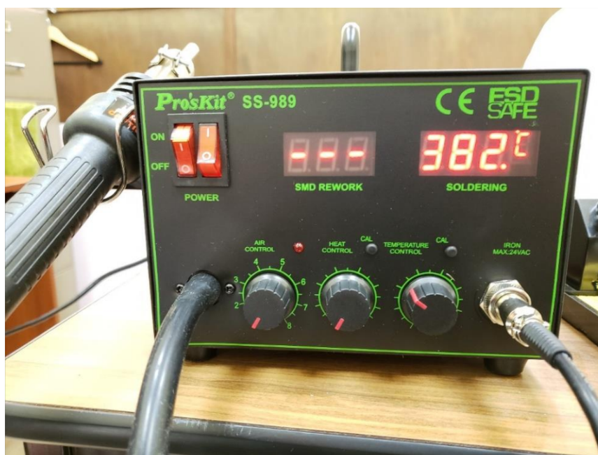
Figura 3.1 Estación de soldadura utilizada para la conectorización de las placas.
