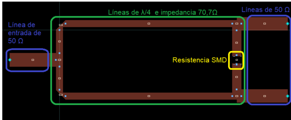
Figura 2.7 Layout del diseño del divisor de potencia Wilkinson.
