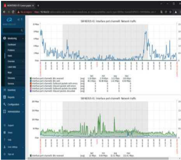
(a) Curvas de tendencias realizadas con base en los datos recibidos por medio del protocolo SNMP - Interfaces de red
