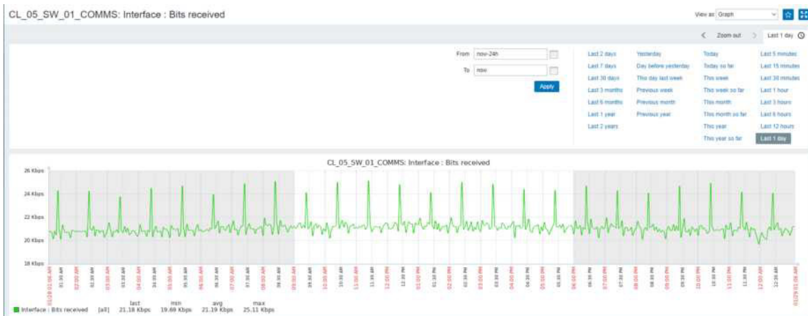
Figura 2.150: Visualización los datos de tráfico recibidos a través del protocolo SNMP sobre el equipo ingresado
