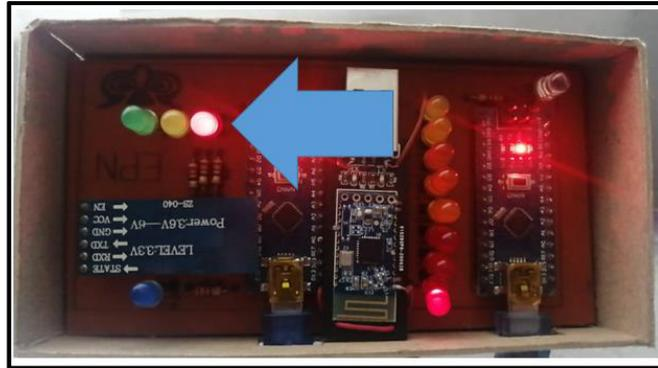
**Figura 3.29** LED rojo indica que no hay conexión
