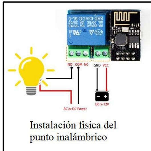
**Figura 3.43** Representación física de la instalación de un punto inalámbrico
