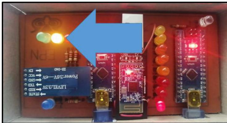
**Figura 3.30** Indicador de conexión sin recepción de datos
