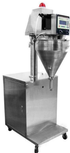
Figura 2.5. Dosificador por tornillo sin fin vertical [6]
