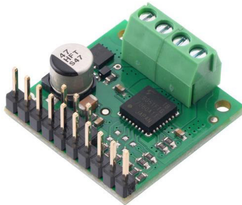
Figura 2.37. Modulo controlador de motor de CC con escobilla simple
