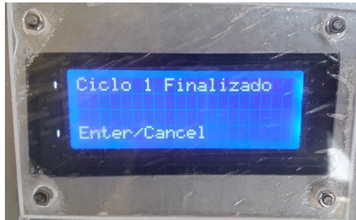
Figura 3.26. Fin de ciclo de dosificación en mando local
