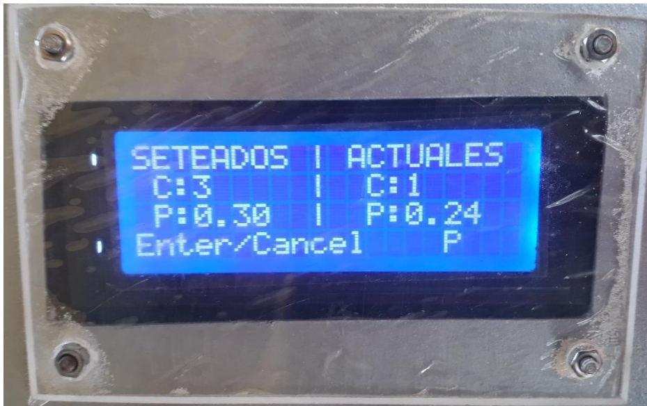
Figura 3.24. Ciclo de dosificación pausada en el prototipo
