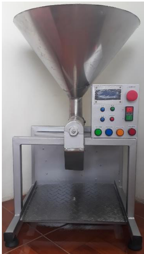
Figura 3.1. Prototipo dosificador construido
