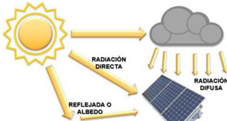
**Figura 2.8** Tipos de Radiaciones Solares [13]
