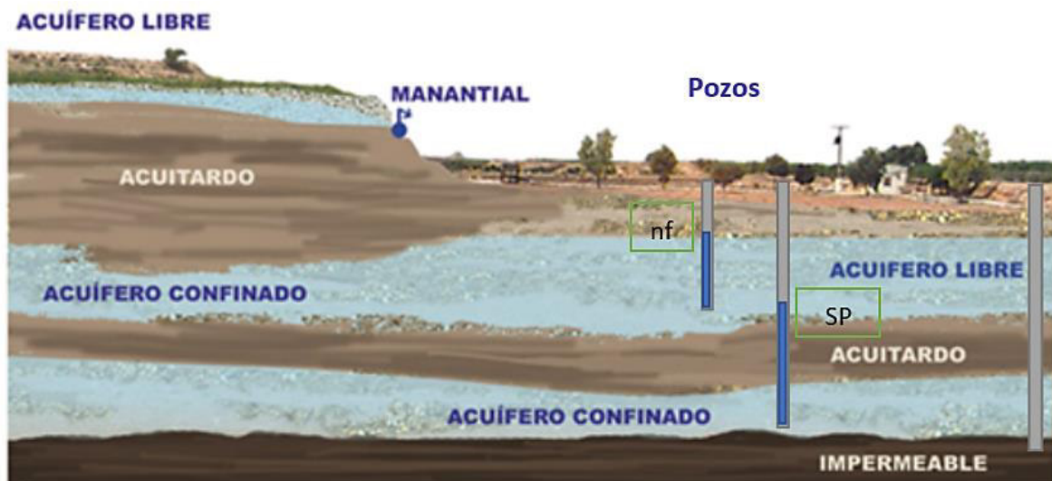
Ilustración 2-4 Tipos de acuíferos según sus características hidrodinámicas. El nivel freático (nf) indica el nivel de agua para el acuífero libre, mientras que la superficie piezométrica (SP) corresponde al nivel de agua del acuífero confinado. Fuente: Sistema Integra
