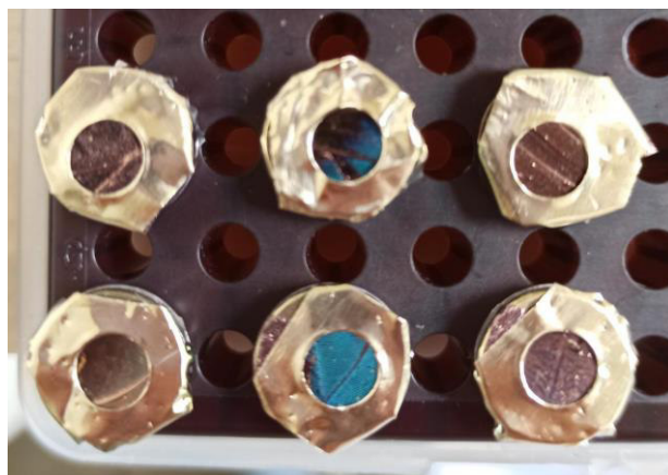
Figura 8. Ubicación en portamuestras para observación en SEM
