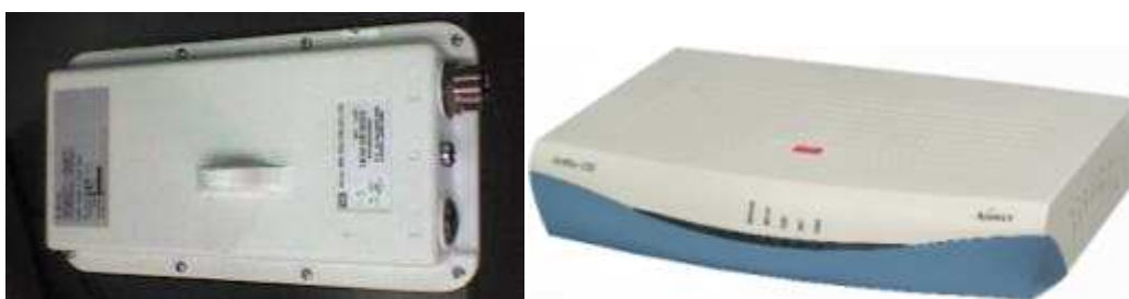
Figura 1.38 Equipo Airmux, izquierda transceiver, derecha unidad interior
