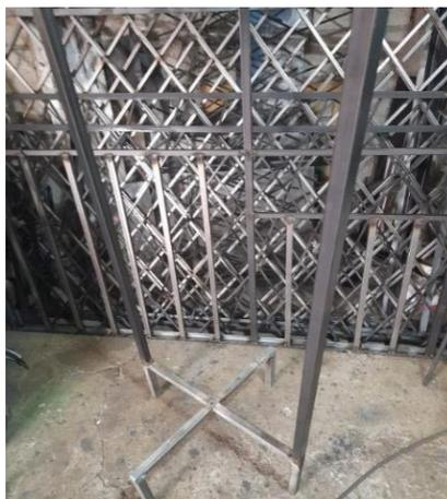
**Figura 2-65** Estructura de Soporte del diseño final del aerogenerador Savonius [autoría propia].
