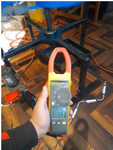
**Figura 3-25** Prueba del voltaje con traslape en relación 3 [autoría propia].
