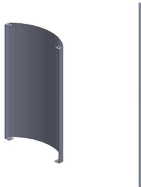
**Figura 2-28** Alabe y eje central para el aerogenerador [autoría propia].
