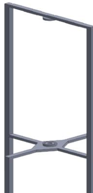
**Figura 2-33** Estructura de soporte para el aerogenerador [autoría propia].
