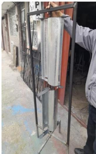
**Figura 2-67** Unión de las alabes a las crucetas y el eje junto a la estructura de soporte del diseño final del aerogenerador Savonius [autoría propia].
