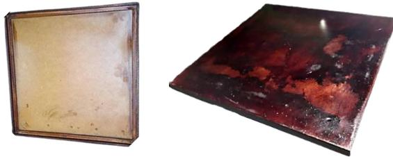
**Figura 2-50** Contenedor a base de MDF y laurel con gradilla de soporte en el interior (vistas superior e inferior) [autoría propia].
