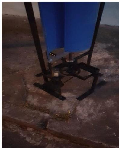
**Figura 2-71** Sistema de Poleas del aerogenerador Savonius [autoría propia].
