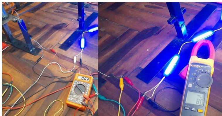
**Figura 3-28** Valor de voltaje y corriente con una carga del aerogenerador Savonius [autoría propia].
