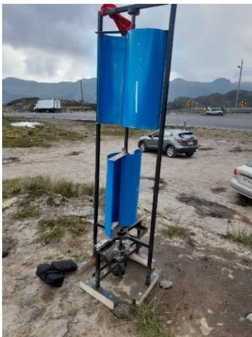
**Figura 2-72** Diseño final del aerogenerador Savonius [autoría propia].
