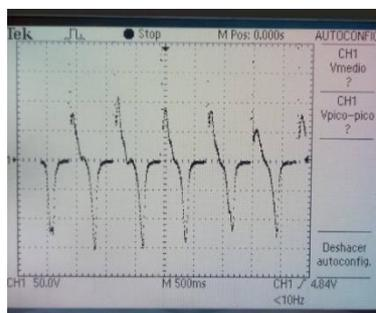
**Figura 3-6** Forma de onda de Voltaje de salida de la baldosa piezoeléctrica propuesta [autoría propia].
