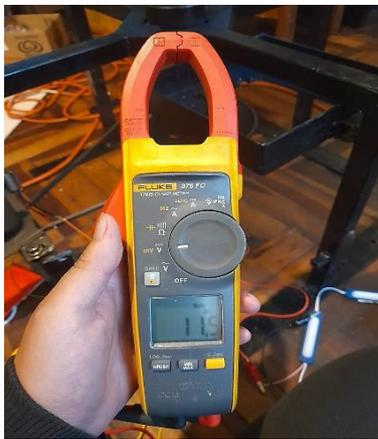
**Figura 3-22** Prueba del voltaje con traslape en relación 2 [autoría propia].
