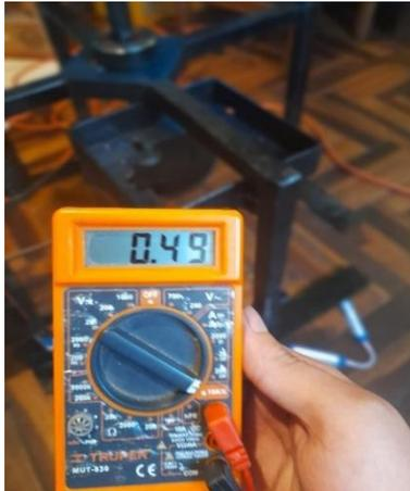
**Figura 3-26** Prueba de la corriente con traslape en relación 3 [autoría propia].
