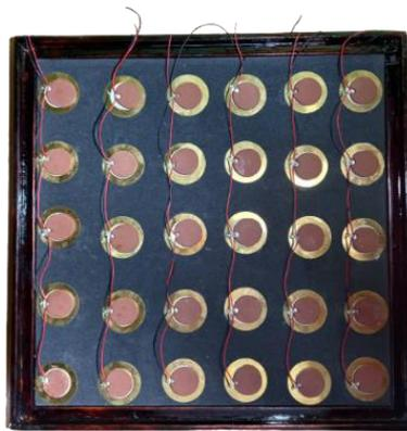
**Figura 2-54** Discos piezoeléctricos asentados sobre los sensores [autoría propia].
