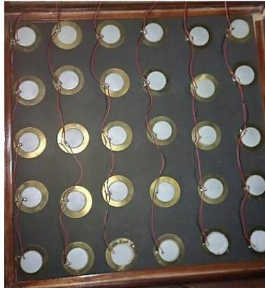
**Figura 3-5** Seis columnas de piezoeléctricos conectados en serie (cada columna contiene cinco sensores piezoeléctricos conectados en paralelo) [autoría propia].
