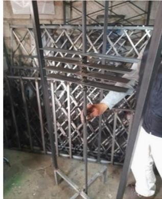
**Figura 2-66** Unión de las crucetas y el eje junto a la estructura de soporte del diseño final del aerogenerador Savonius [autoría propia].
