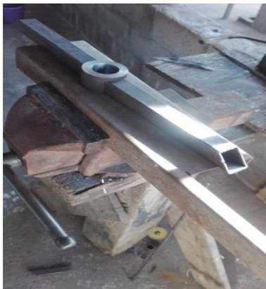
**Figura 2-59** Unión vigas con el rodamiento central del prototipo [autoría propia].
