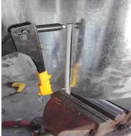
**Figura 2-62** Alabe de tol galvanizado junto al eje de PVC [autoría propia].
