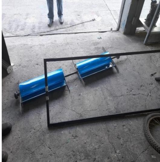
**Figura 2-68** Pintura de los alabes y de la estructura de soporte del diseño final del aerogenerador Savonius [autoría propia].
