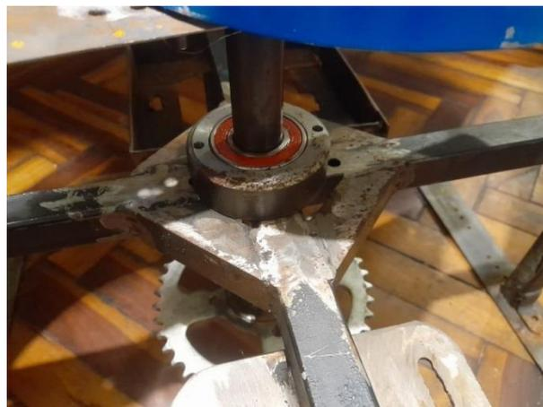
**Figura 2-69** Unión de los rodamientos 6205 al conjunto previamente armado del diseño final del aerogenerador Savonius [autoría propia].
