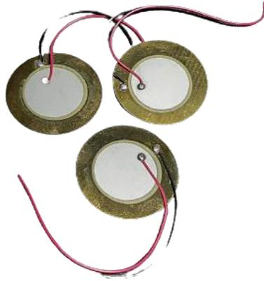
**Figura 2-48** Sensores piezoeléctricos [40].
