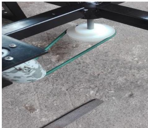
**Figura 2-63** Sistema de poleas del prototipo [autoría propia].
