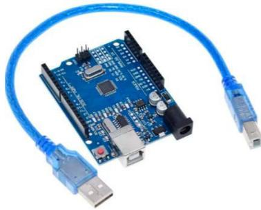
**Figura 2-73** Modelo Arduino Uno R3SMD.
