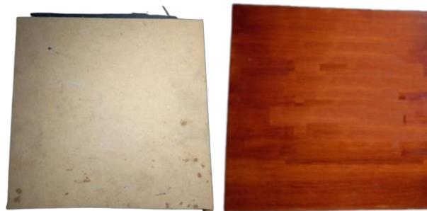
**Figura 2-49** Pieza cuadrada de MDF para soporte. (Izquierda: Pieza cortada, Derecha: Resultado final) [autoría propia].
