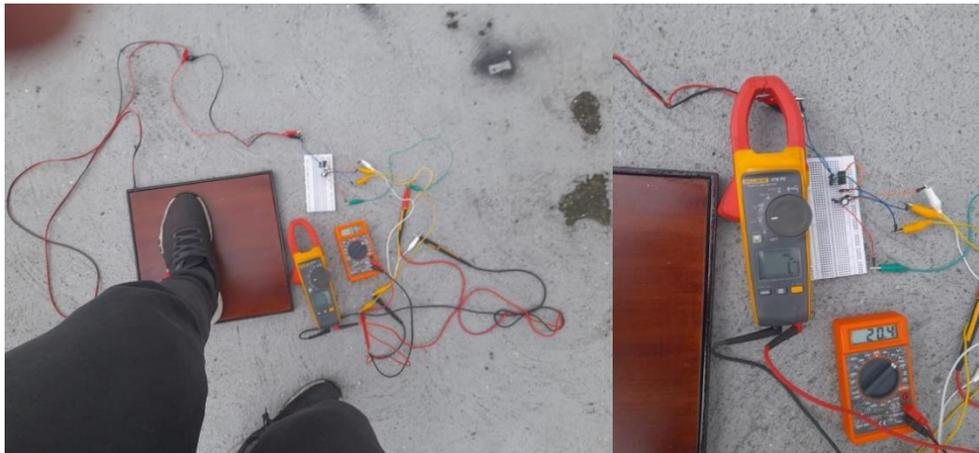
**Figura 3-9** Medición de potencia de las baldosas piezoeléctricas [autoría propia].
