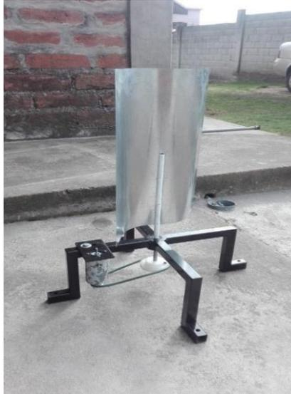
**Figura 2-64** Diseño final del prototipo de aerogenerador Savonius [autoría propia].
