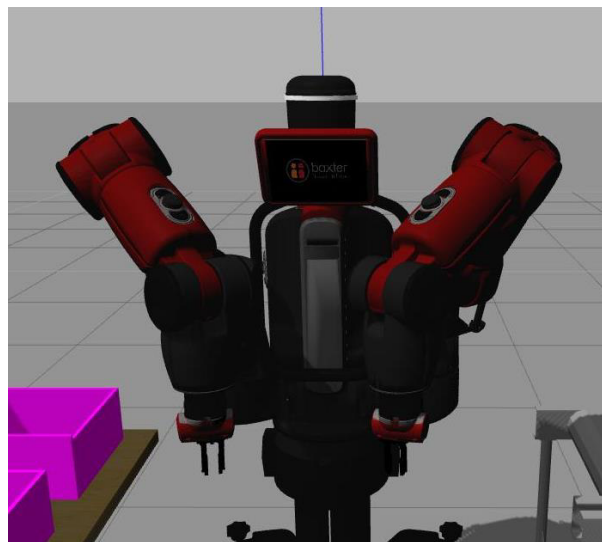
Figura 2.14 Posición de destrabe de los brazos del robot Baxter.
